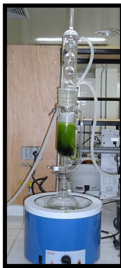
Fig. N° 7 Aparato de extracción Soxhlet.
