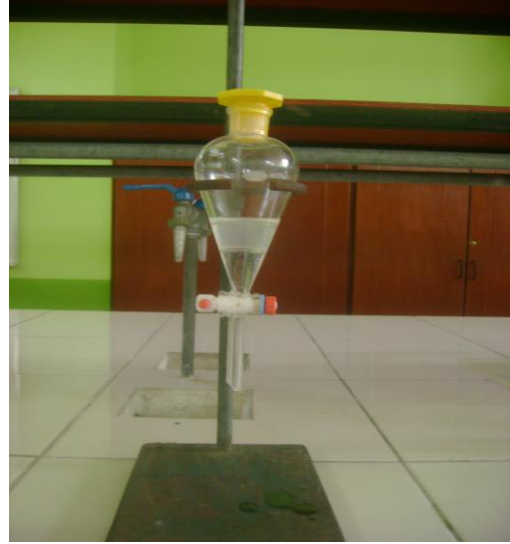
B) Separación de Aspartame y Acesulfame K de el jugo
