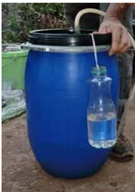
Anexo 2. Sellado de barril y conectado a su sistema de evacuación de gases.
