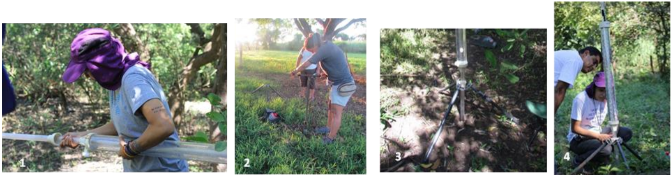
Figura 26. Proceso de 1) Montaje, 2) Preparación del agujero, 3) Instalación y 4) Toma de datos del permeámetro de Guelph (Fuente: Elaboración Propia).
