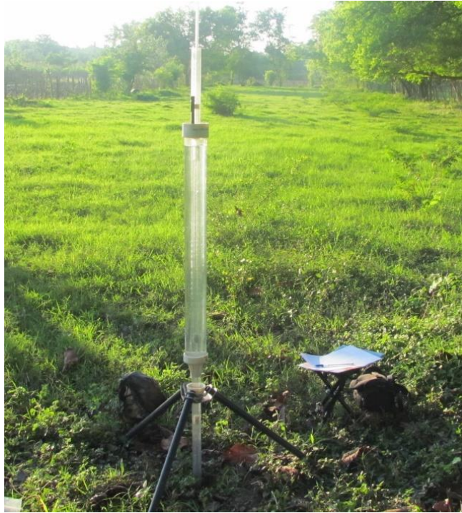
Figura 15. permeámetro de Guelph armado en campo Fuente: (foto propia)
