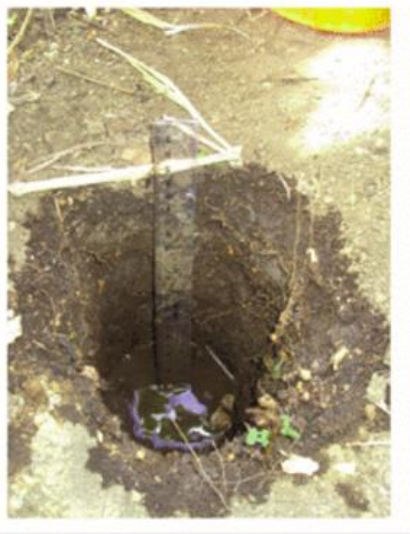
Figura 19. Método de Porchet utilizado en el campo, para la determinación de la conductividad hidráulica. (Alvarado C, 2015)
