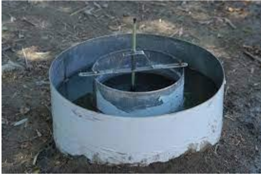
Figura 17. El infiltrómetro de doble anillos enterrados en campo. (Alvarado C, 2015)
