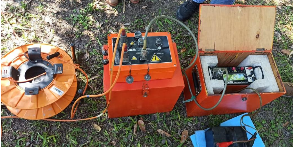
Figura 13. Equipo utilizado para realizar tomografías eléctricas. Fuente: (fotografía propia)
