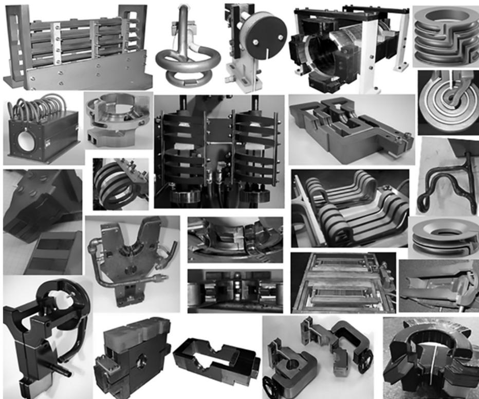
Fig. 1.16. Variedad de geometrías de inductores utilizados en calentamiento por inducción [15].
