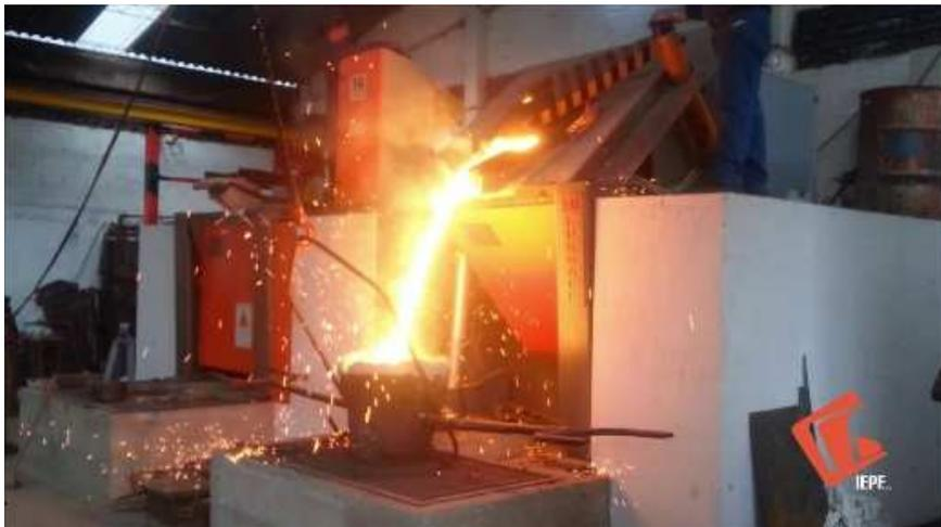
Fig. 1.11. Fundición por medio de un horno de inducción [7].
