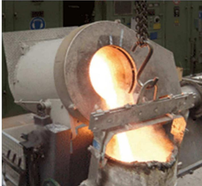
Fig. 1.12. Horno de inducción AMFH de inducterm sin núcleo [14].
