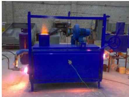
Fig. 1.3. Horno a quemador a gas para tratamiento térmico [5].
