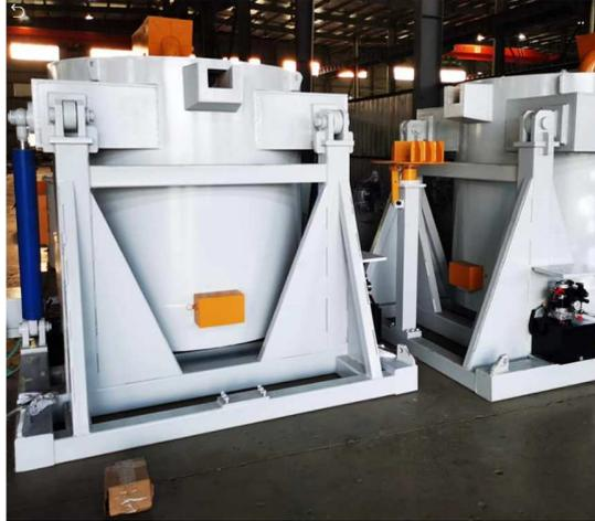
Fig. 1.4. Horno a fuel oil para fundición de aluminio [6].
