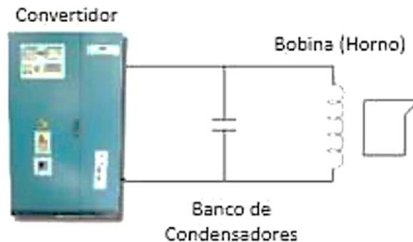
Fig. 1.22. Sistema de resonancia en paralelo [12].
