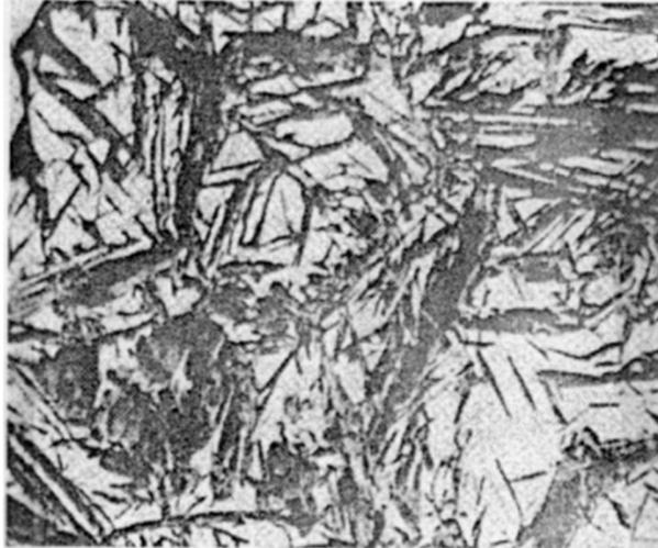
Fig. 1.48. Fotomicrografía de un acero con microestructura martensítica. Los granos en forma de aguja es la martensita y las regiones blancas es austenita retenida [22].
