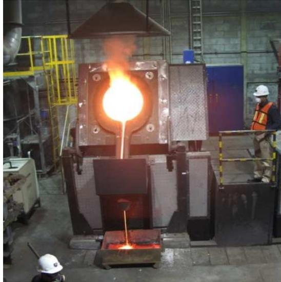
Fig. 1.5. Horno eléctrico de inducción sin núcleo para fundición [8].
