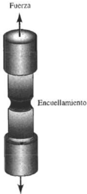
Fig. 1.3. Estricción de probeta durante un ensayo tracción [2].
