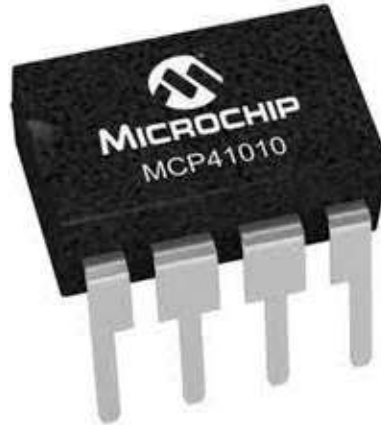
Fig. 2.21. Potenciómetro digital MCP41010 [25].
