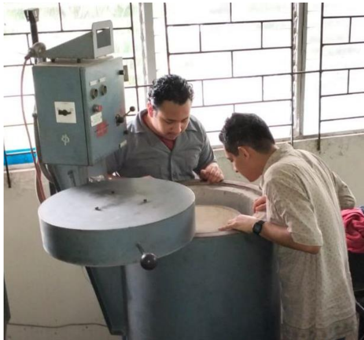
Fig. 2.1. Inspección de la Cámara de carga del horno de nitruración.
