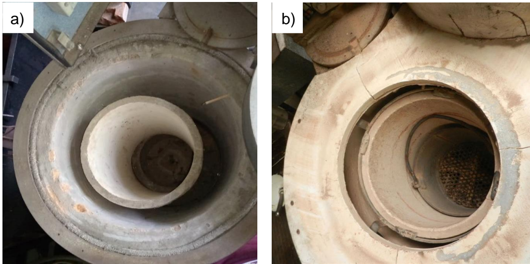
Fig. 3.27. Sistema de sellado de atmósfera: a) Horno sin la tapadera superior o top plate, b) horno con tapadera superior y anillo de soporte.
