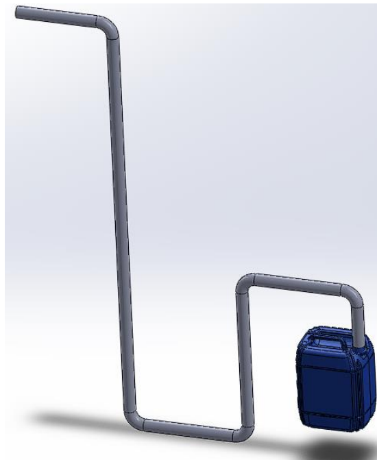
Fig. 3.31. Sistema de evacuación y tratamiento de gases de escape.
