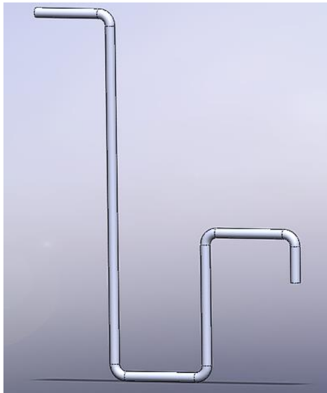
Fig. 3.30. Tubería de evacuación de gases.
