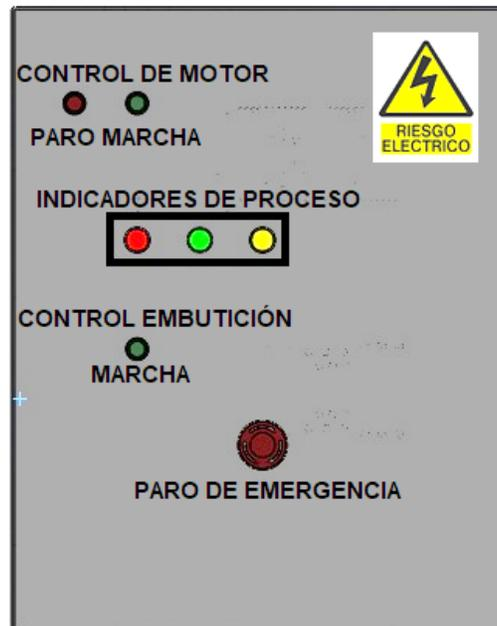
Fig. 3.8. Tablero de control de la máquina embutidora para piezas pequeñas de baja penetración.
