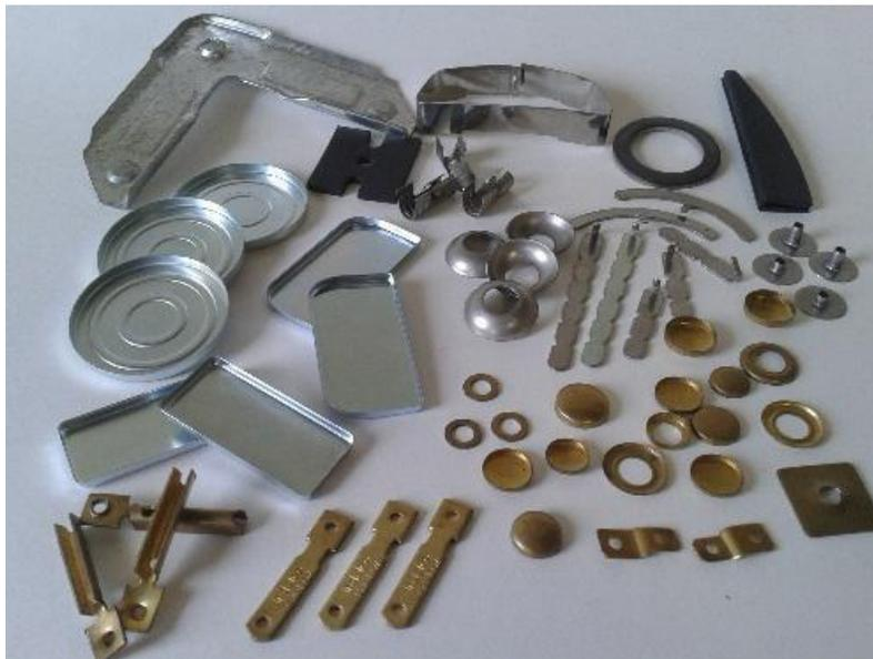
Fig. 1.15. Piezas fabricadas por procesos de troquelado.
