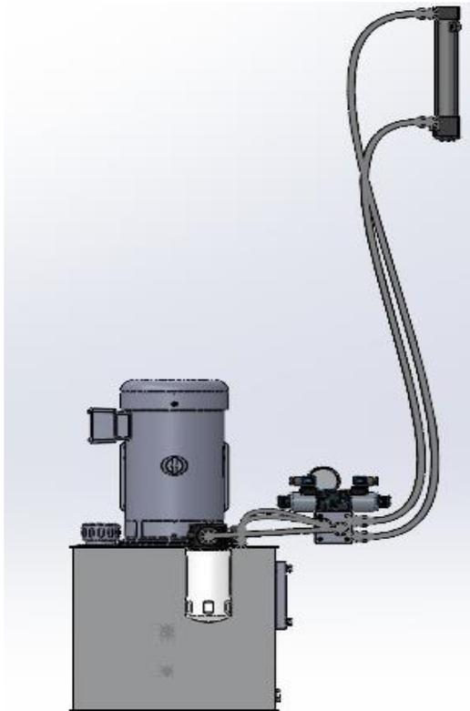
Fig. 3.4. Vista de componentes indicando las mangueras hidráulicas a utilizar.
