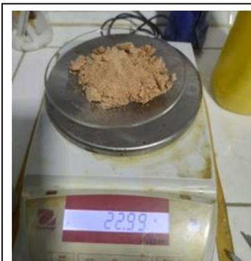
La quitina neutralizada (pH=7) sometió a un proceso de secado con el que se estimó la cantidad de carbonatos de calcio y proteínas que se eliminaron en la desmineralización y desproteínización.
