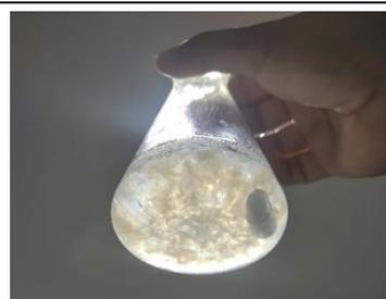
Se tituló agregando 1 ml a la vez de hidróxido de sodio 0.1 M hasta alcanzar un total de 50 ml añadidos. Con cada ml de hidróxido de sodio dosificado, se registró el pH de toda la solución.
