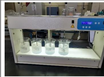
Cada vaso de precipitado se coloca en agitación en el equipo para pruebas de jarras contante a 220 rpm por 20 min.
