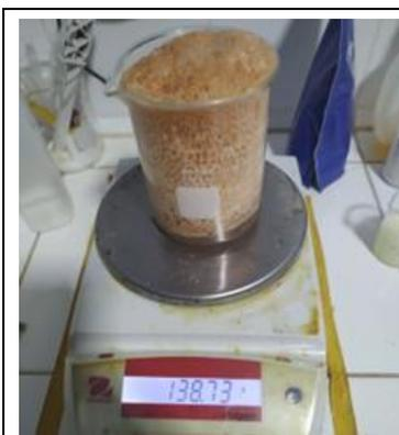
La muestra previamente acondicionada se desmineralizó con una solución de ácido clorhídrico (HCl) al 5.4% p/v en una relación 1:5, durante 2 horas con agitación constante 170 rpm.
