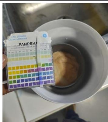
Se filtró y lavo con agua destilada hasta obtener pH neutro.
