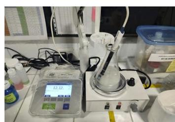
Se realizó una valoración potenciométrica ácido-base, disolviendo 0.5 g de quitosano en 10ml de alícuota de ácido clorhídrico con una concentración de 0.3 M.
