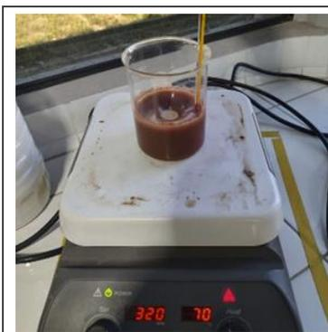
Para la síntesis de quitosano se utilizó una solución de NaOH al 60% p/v a 70°C con agitación constante de 320 rpm, durante 8 horas.
