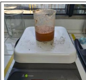
La desproteínización se realizó con una solución de NaOH 0.1 M en una relación de 1:10, durante 1 hora a 60°C con agitación constante a 170 rpm
