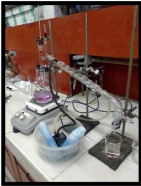
Purificación de etanol para utilizarlo con fines de higienización en áreas de trabajo, por medio de destilación.
