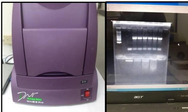
5. Visualización del producto PCR a través del Transiluminador, y documentado de las fotografías con las bandas del gen ITS2.
