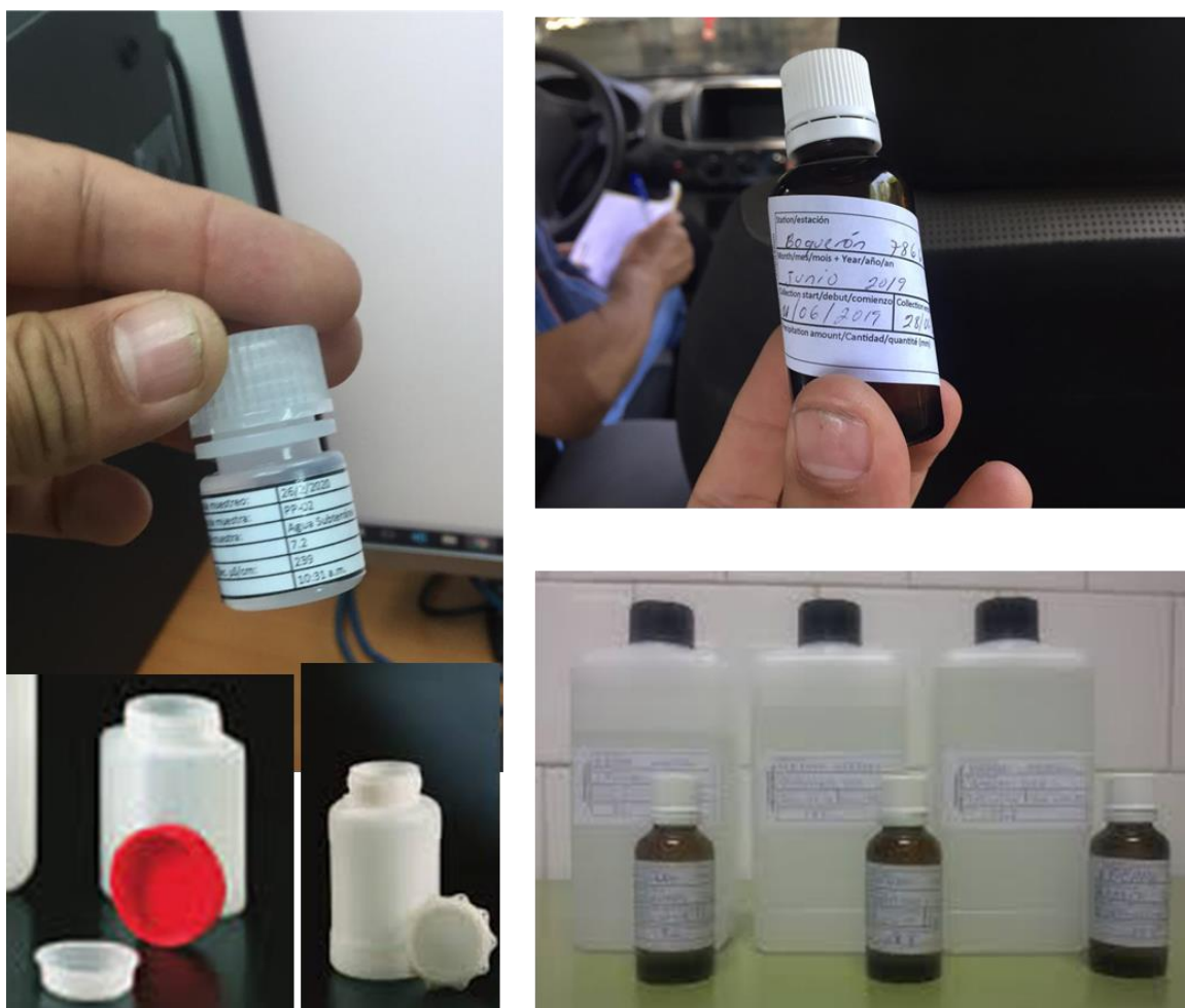
Figura 3.2 Frascos recomendados para la toma de muestras de agua para análisis de isótopos \text{O}18 , \text{H}2 y \text{H}3
