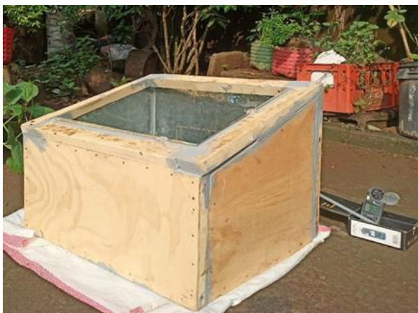
a. Toma de temperatura interna (sin muestra)
