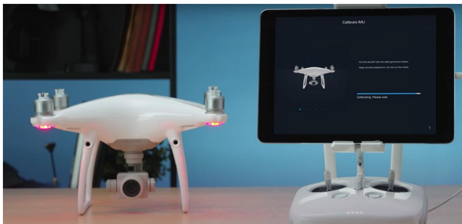
Imagen 2 - 55 Indicaciones de calibración para el dron.
