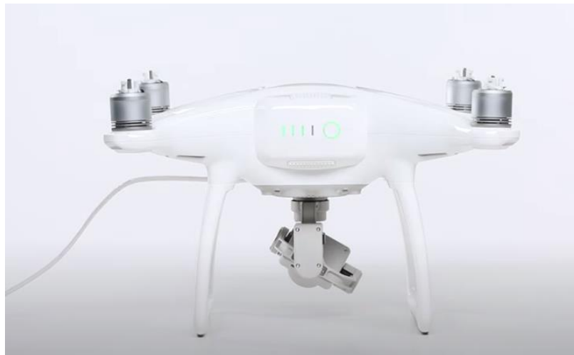
Imagen 2 - 38 Verificación de encendido del Dron Phantom 4.
