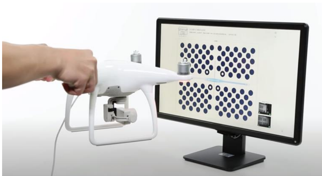
Imagen 2 - 46 Representación del movimiento para calibración (izquierda a derecha).
