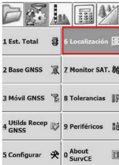
Imagen 3 - 13 Configuración del sistema de proyección local en la aplicación SurvCE.
