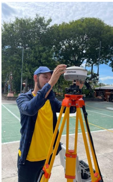
Imagen 3 - 8 Colocación de receptor base sobre el punto “BASE RTK SAN ISIDRO”.
