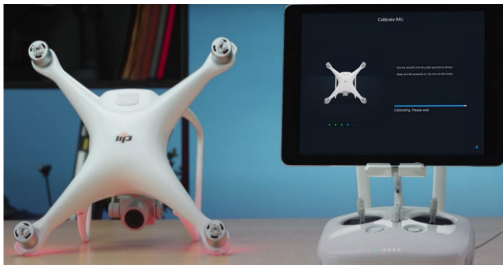
Imagen 2 - 59 Indicaciones de calibración para el dron.
