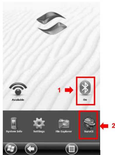
Imagen 3 - 9 Activación del bluetooth en la aplicación SurvCE.
