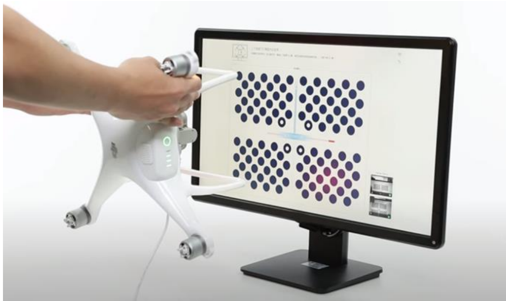
Imagen 2 - 48 Representación del movimiento para calibración (arriba y hacia abajo).
