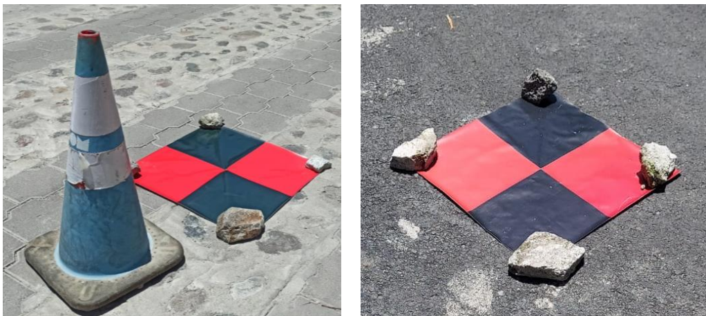
Imagen 3 - 5 Puntos de control fotogramétricos colocados en el área del proyecto.
