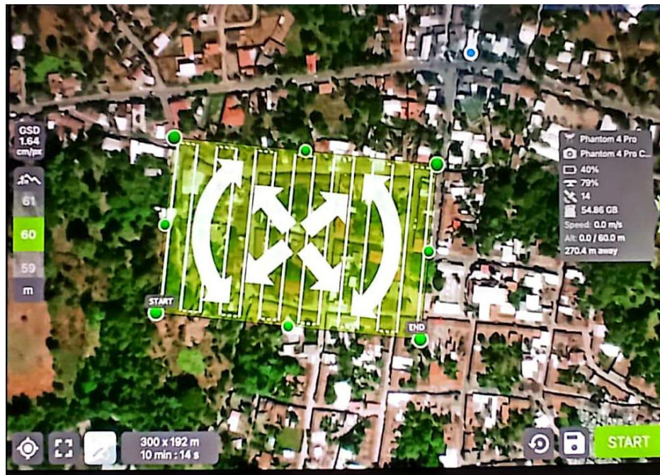
Imagen 3 - 42 Delimitación del área del proyecto con la misión de vuelo GRID.
