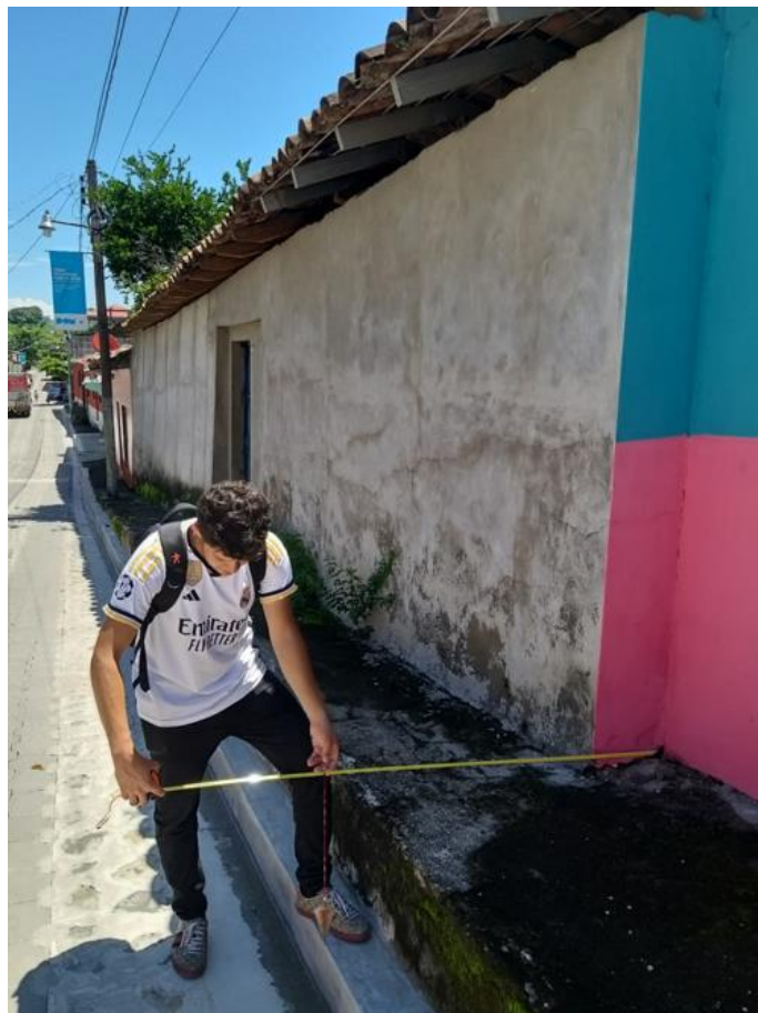
Imagen 3 - 43 Medición con cinta y plomada.
