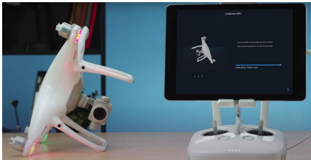
Imagen 2 - 58 Indicaciones de calibración para el dron.
