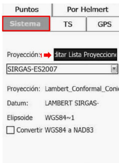
Imagen 3 - 14 Configuración del sistema de proyección local en la aplicación SurvCE.
