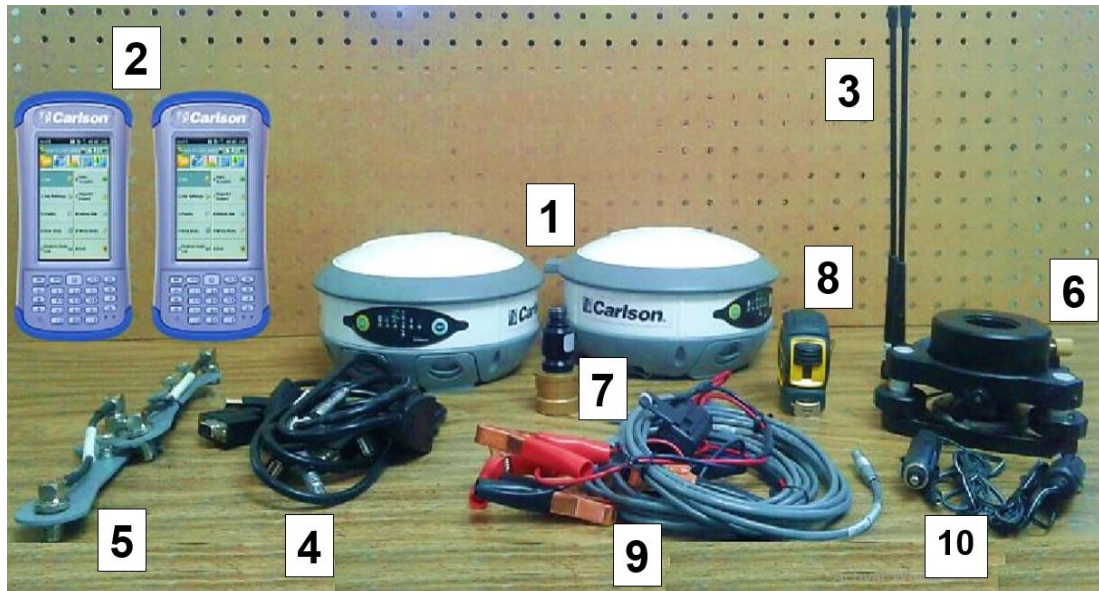
Imagen 3 - 6 Componentes del equipo GNSS de la marca Carlson.
