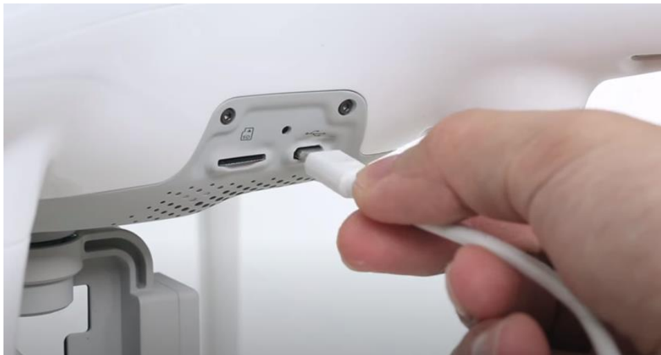
Imagen 2 - 36 Conexión (ordenador – Phantom 4) por cable USB.
