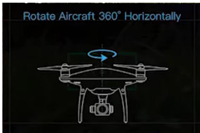
Imagen 2 - 65 Indicaciones para la calibración de la brújula.
