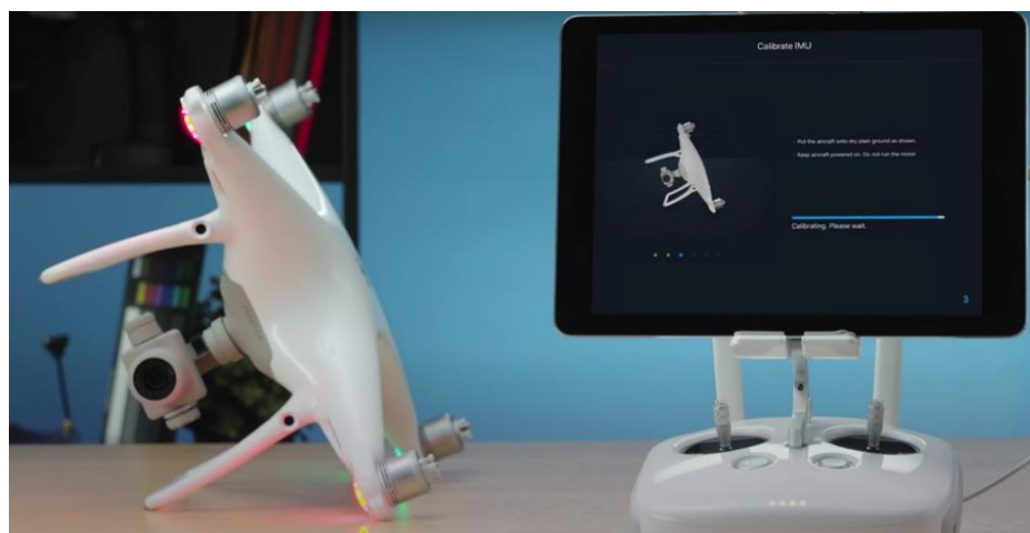
Imagen 2 - 56 Indicaciones de calibración para el dron.
