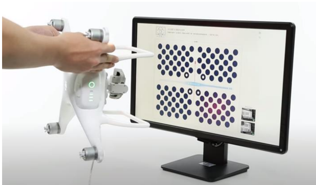
Imagen 2 - 49 Representación del movimiento para calibración (izquierda a derecha).
