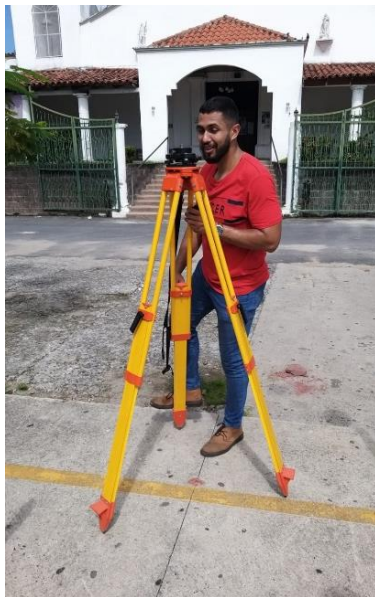
Imagen 3 - 7 Centrado y nivelado del trípode sobre el punto “BASE RTK SAN ISIDRO”.
