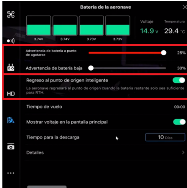
Imagen 2 - 74 Configuración de batería de la aeronave.
