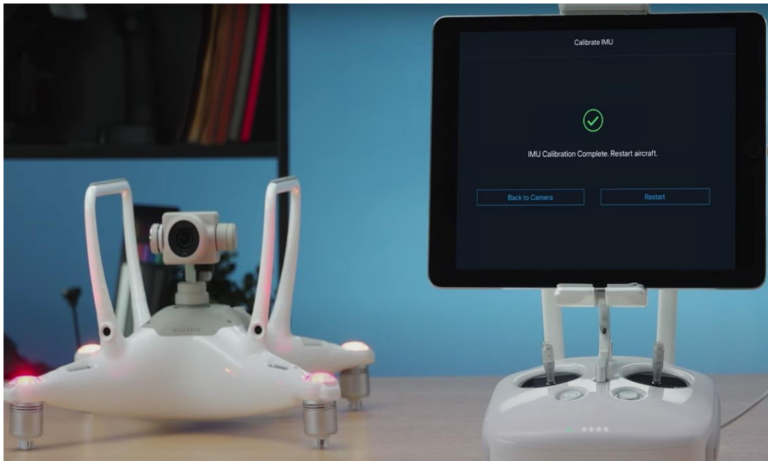
Imagen 2 - 61 Se finaliza la calibración para el dron.
