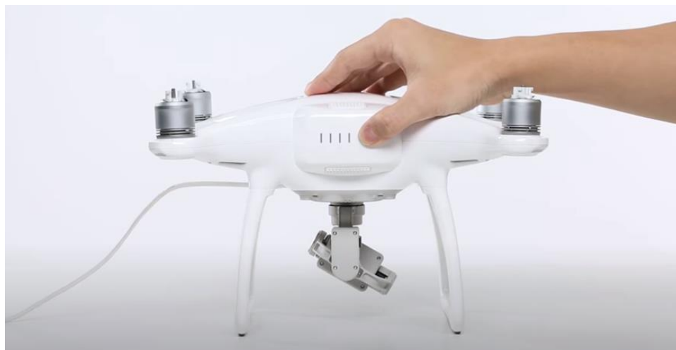
Imagen 2 - 37 Proceso de encender el Dron Phantom 4.
