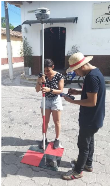
Imagen 3 - 31 Colocación de receptor móvil en el PCF1.
