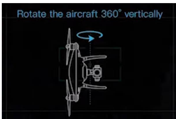
Imagen 2 - 66 Indicaciones para la calibración de la brújula.
