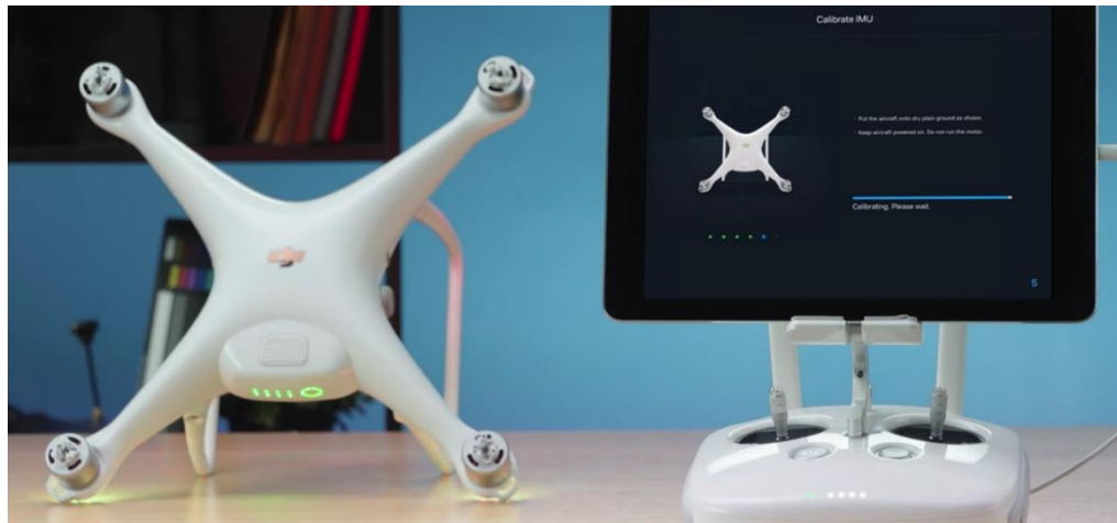
Imagen 2 - 57 Indicaciones de calibración para el dron.
