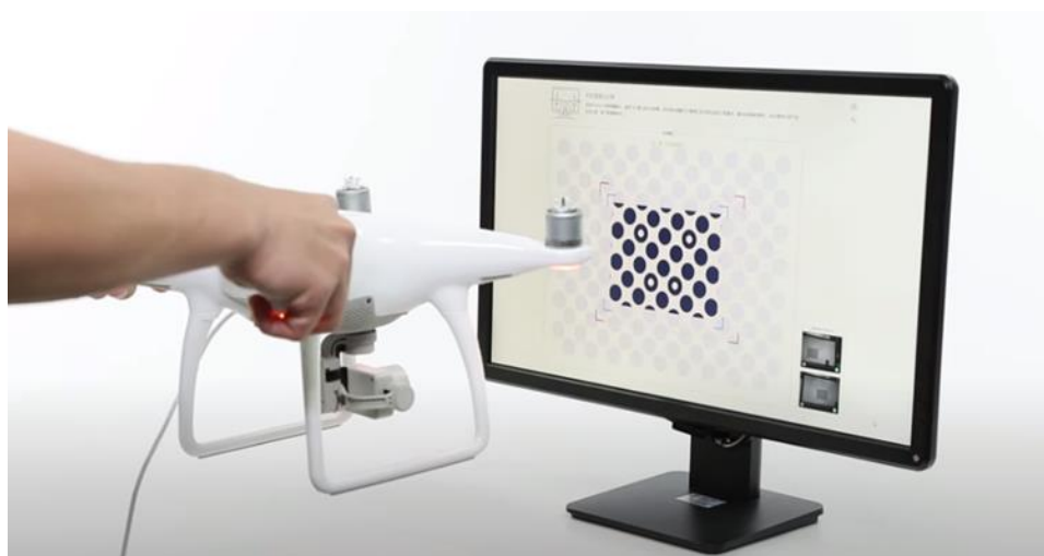
Imagen 2 - 44 Representación del movimiento para calibración (adelante y hacia atrás).
