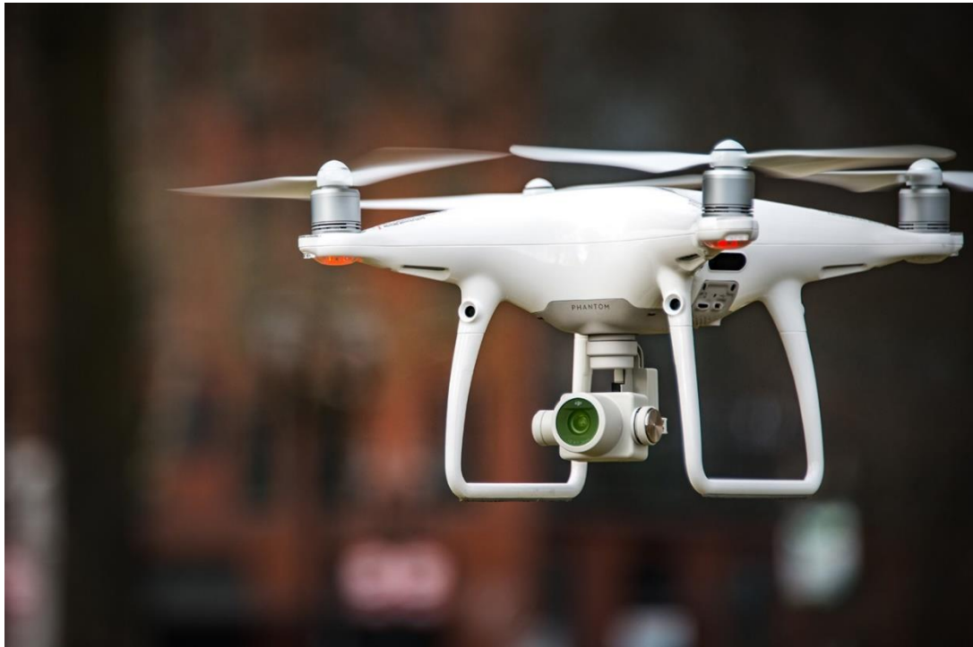
Imagen 2 - 68 Representación del dron phantom 4 y el gimbal.
