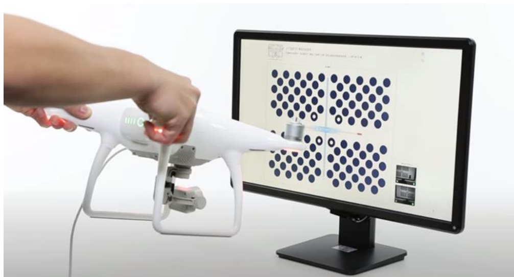
Imagen 2 - 45 Representación del movimiento para calibración (arriba y hacia abajo).
