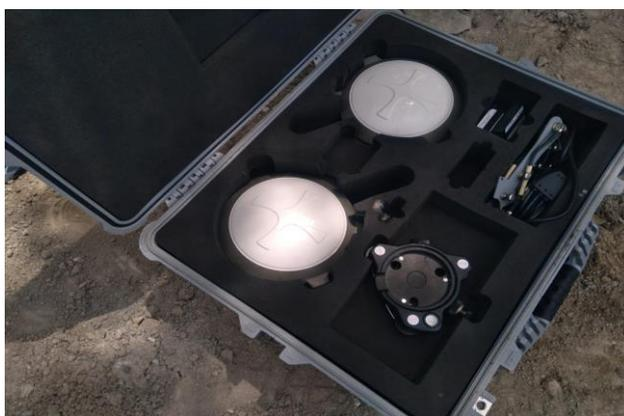
*Imagen No 9-6. Equipo GPS usado para el levantamiento de los puntos de control.
