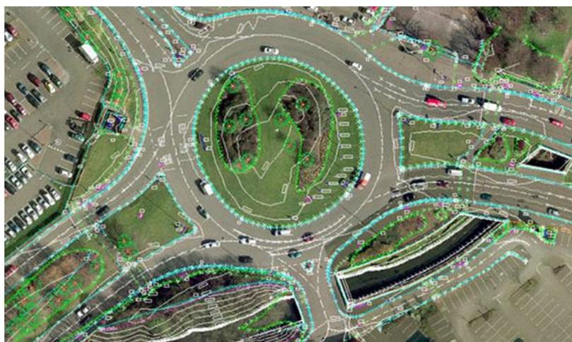
*Imagen No 7-4. Restitución fotogramétrica con el uso de drones y procesada mediante software.*
