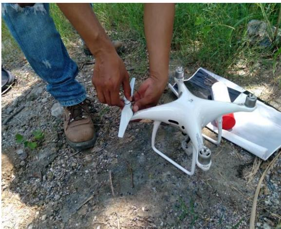
*Imagen No 10-9. Ensamble de hélices.*
