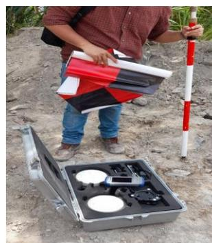
*Imagen No 9-8. Llevando lonas a su lugar para levantamiento de puntos de control.*
