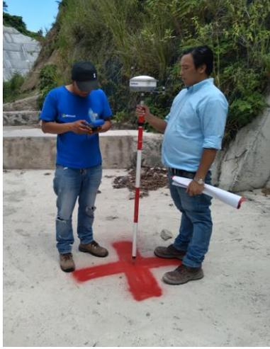
*Imagen No 9-12. Levantando punto de control con el uso del rover.
