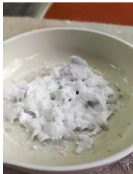
Figura 12. Estructura de espuma de un composite al finalizar el proceso de calcinación.
