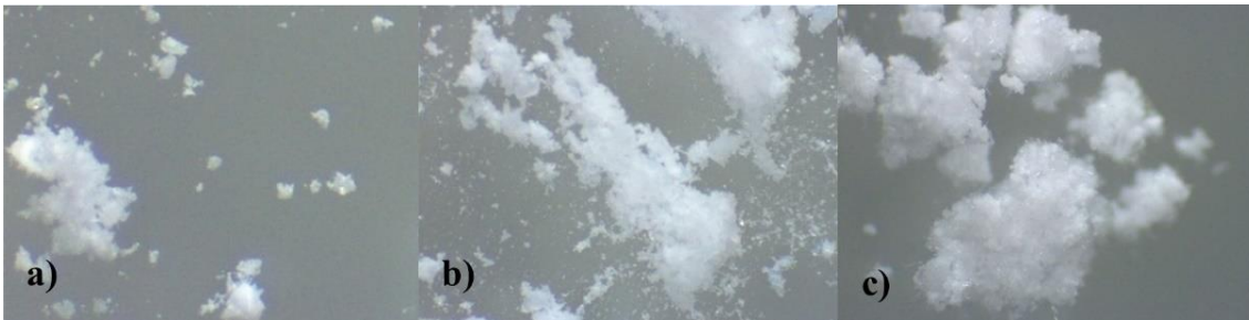
Figura 41. Estereoscopias de los composites 1,2 y 3 (a, b y c respectivamente) sintetizados a partir de roca caliza y ceniza de cascarilla de arroz.
