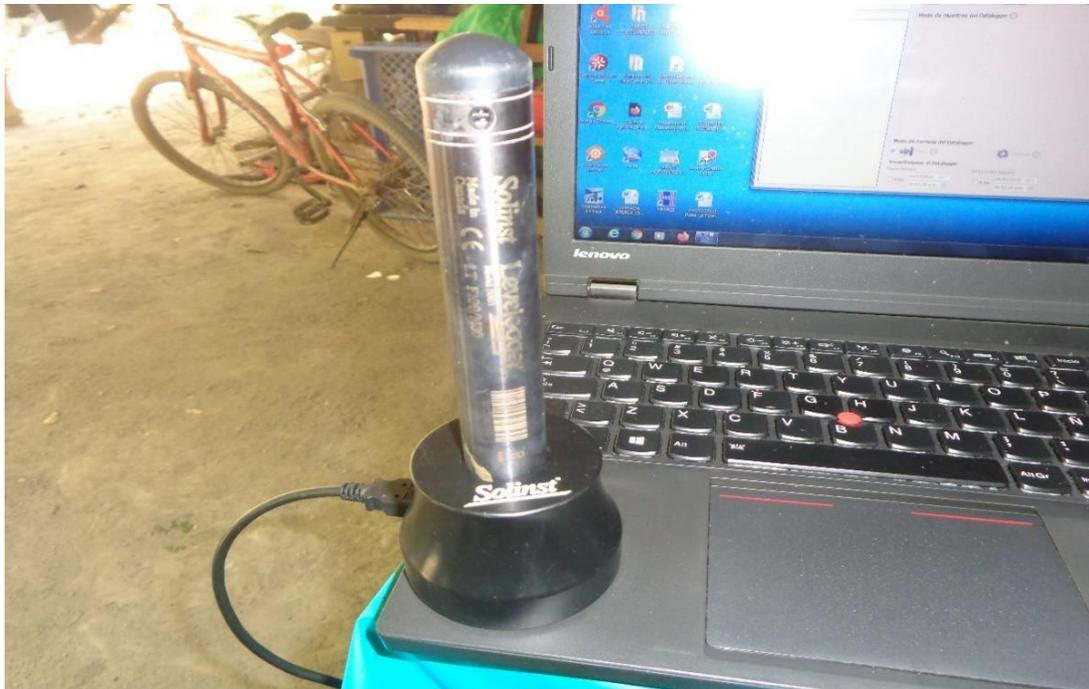
Anexo 28. Descarga de información del Levellogger al software.
