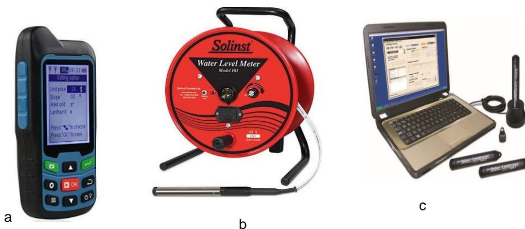
**Anexo 27.** Equipo utilizado en las visitas de campo: a) GPS, b) medidor de agua, modelo 101, y c) Barologger: dispositivo de conexión con la computadora.
