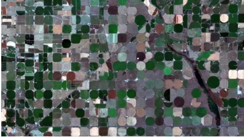
Figura 11: Imagen de resolución espacial media (10 m/píxel) de Sentinel-2 L2A, que permite distinguir los límites de los campos sin detalles de los mismos. Fuente: EOS Data Analytics. (2023d).
