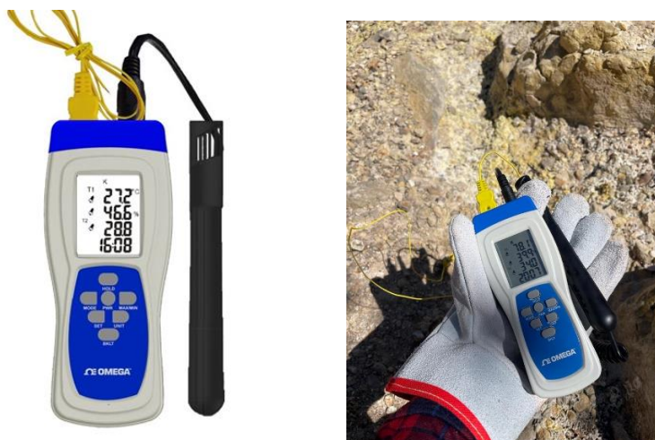
Figura 98: Termómetro e hidrómetro OMEGA. Fuentes: OMEGA. (s/f), Elaboración propia.
