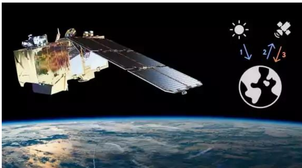
Figura 8: Ilustración de Teledetección Pasiva. Fuente: EOS Data Analytics, 2023e
