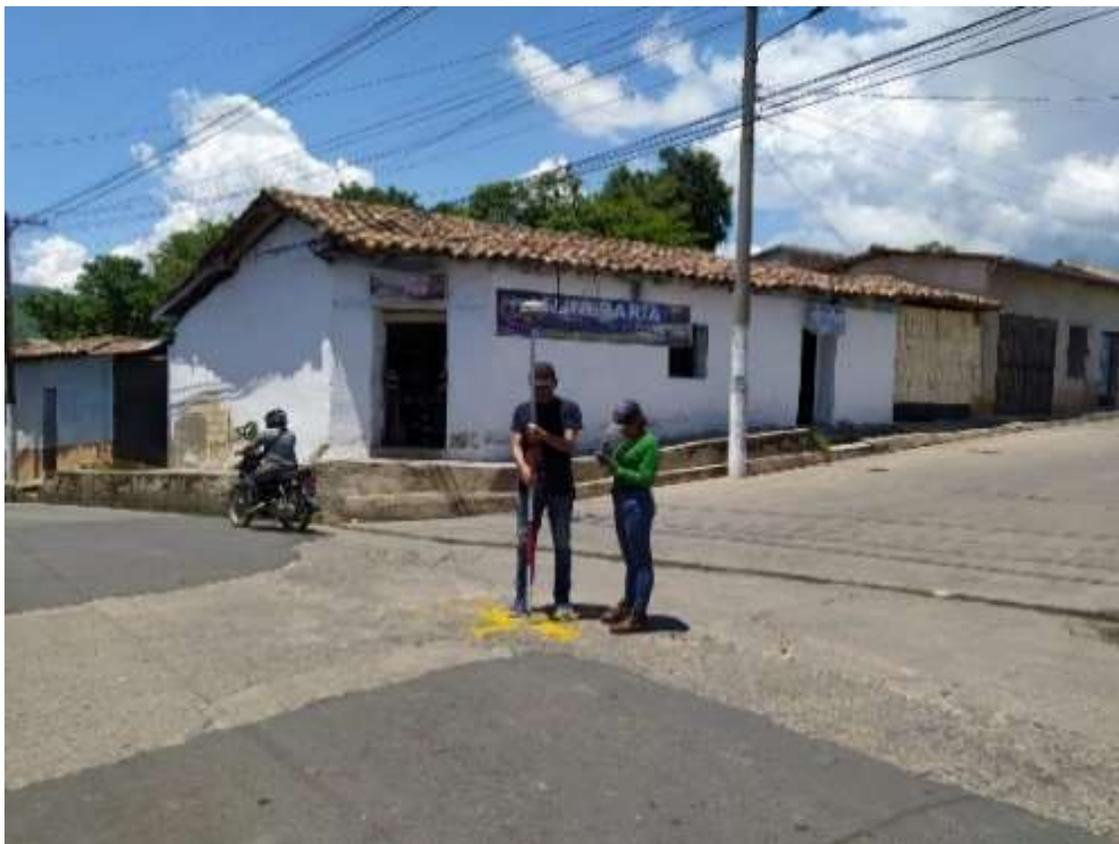
*Imagen 3.2.2. 3: Levantamiento de PCF2, con técnica RTK.*
