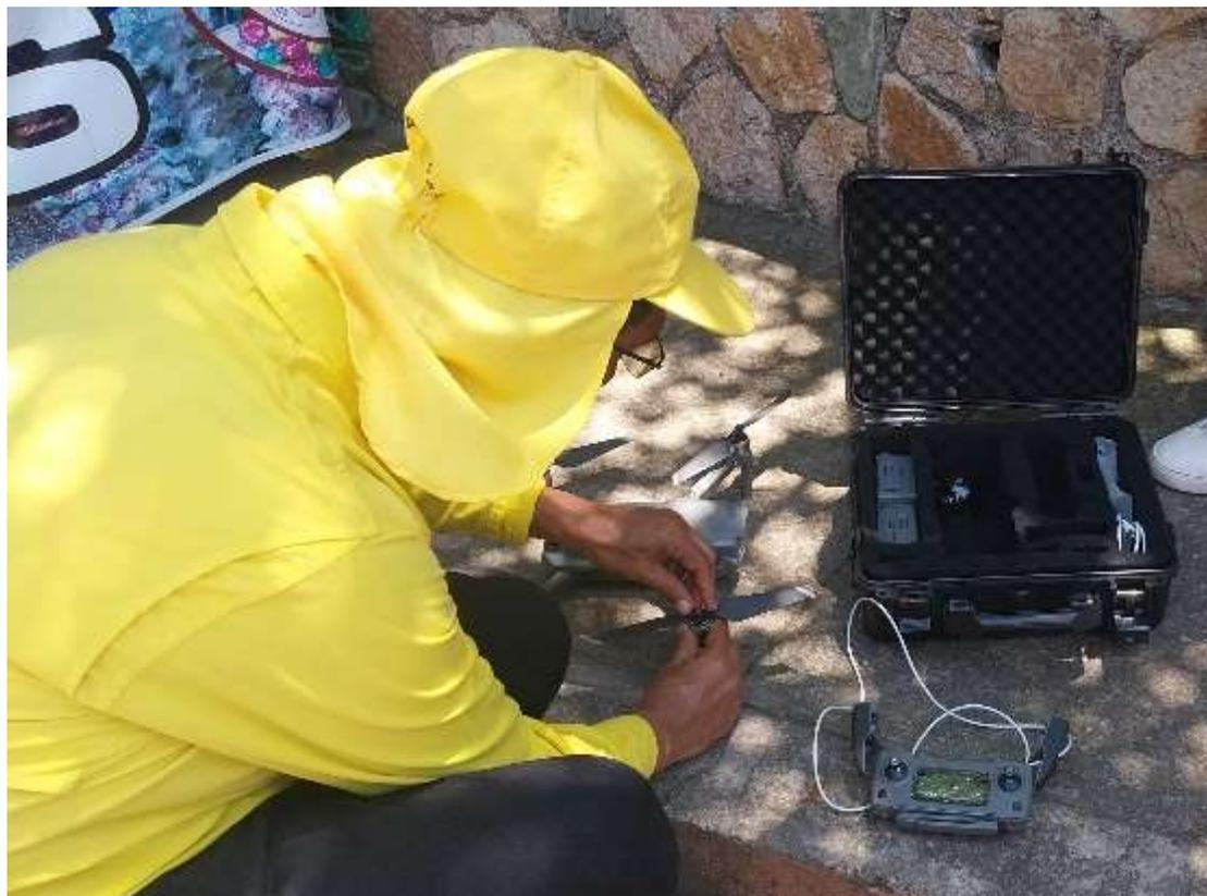
*Imagen 3.4.1. 1: Armado de dron MAVICK 2, instalación de hélices.*
