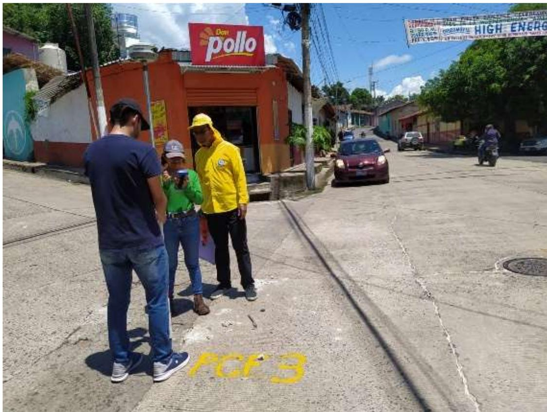
*Imagen 3.2.2. 2: En la imagen se muestra el levantamiento del PCF3 y al lado derecho el PCF3.1
