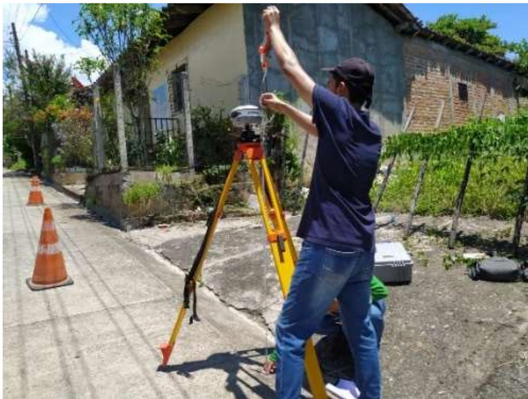
*Imagen 3.2.2.1: Instalación de base RTK.*
