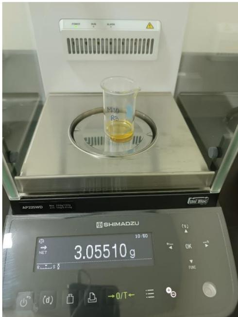
Figura A- 7: Preparación de muestras para análisis de perfil de miel.
