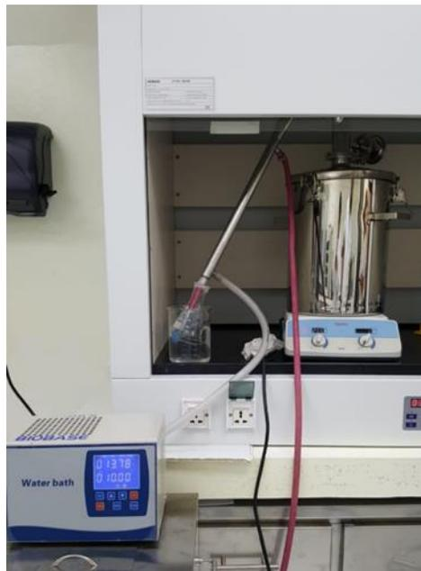
Figura 8. Extracción de aceite de menta por el método de arrastre de vapor.
