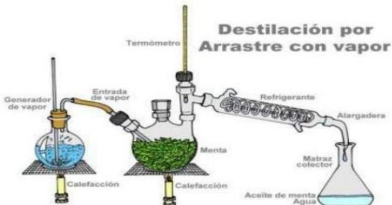
Figura 5. Montaje para la destilación por arrastre de vapor en hoja de menta (Química e hidrocarburos 2018).
