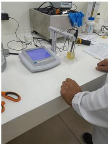
Figura 10. Determinación de conductividad en miel.
