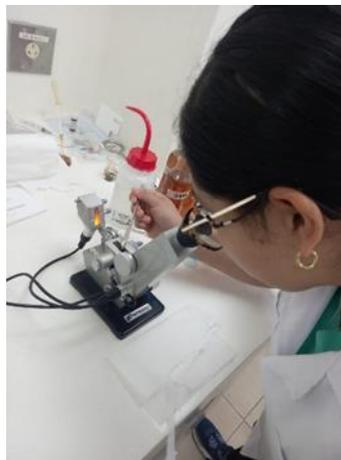
Figura 11. Determinación de grados brix y humedad en miel.
