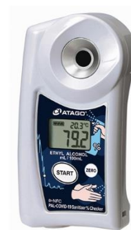
Figura 3.1. Refractómetro de bolsillo Atago (Atago, 2020)
