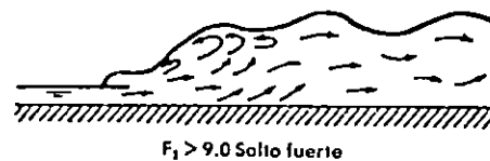
Fig. 5.46: Varios tipos de saltos hidráulicos [10].
