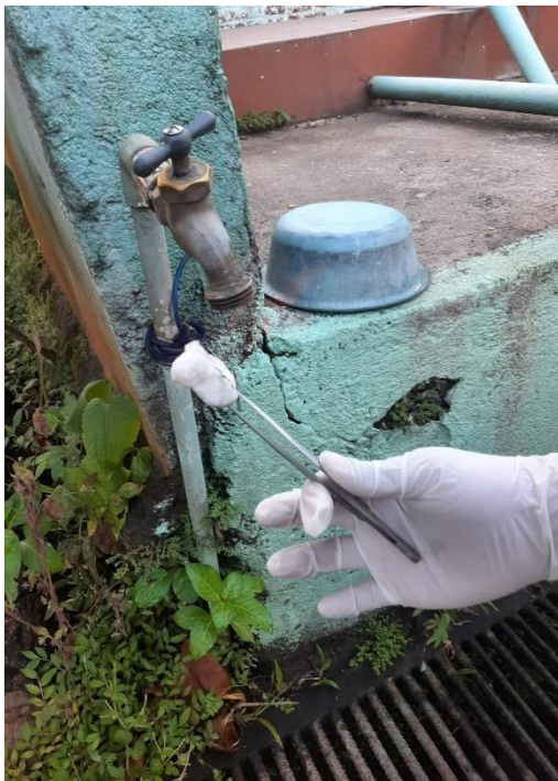
Ilustración A-III Desinfección por flameo en grifo del punto 1
