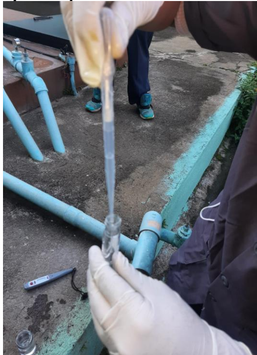
Ilustración A-VIII Llenado de tubos de ensayo para medición de cloro residual libre
