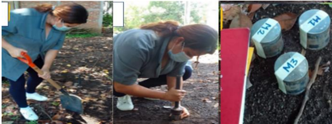
Figura A- 13. Proceso para determinar el Análisis de Densidad Aparente de suelo primera etapa.
