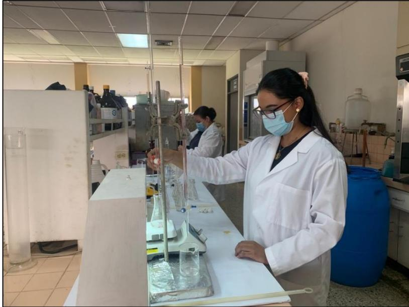
Anexo 20. Lectura con hidrómetro para determinación de textura de suelo por el método de Bouyoucos.
