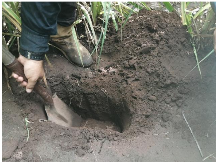
Figura 5. Elaboración de calicata
