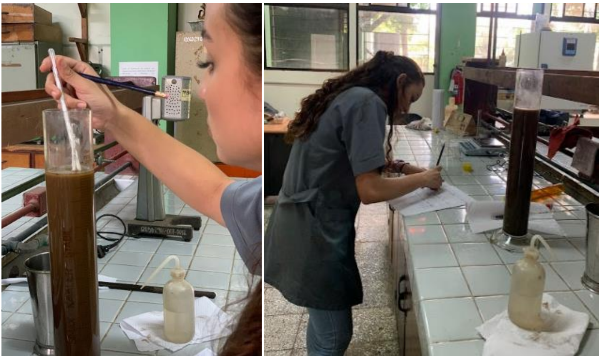
Figura 23 y 24. Toma de lecturas de densidad de temperatura y toma de datos.
