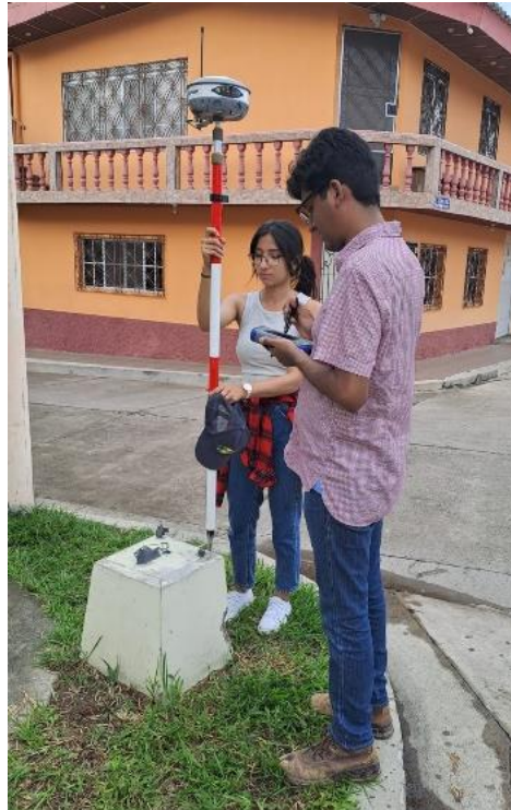
Imagen No. 3.2.2.24. – Toma de punto de control adicional Fuente: Elaboración propia
