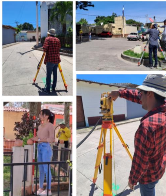
Imagen No. 4.2.1.2. – Trabajos complementarios con estación total Fuente: Elaboración propia
