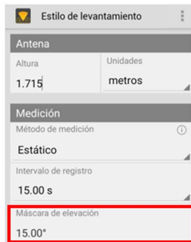
Imagen No. 3.2.1.11. - Selección de la máscara de elevación Fuente: Elaboración propia
