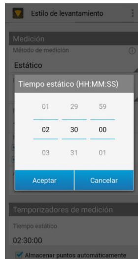
Imagen No. 3.2.1.14. - Configuración del tiempo de observación Fuente: Elaboración propia
