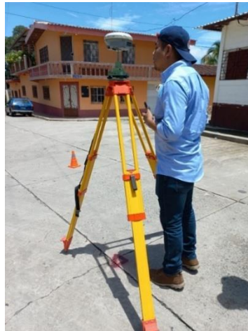
Imagen No. 3.2.1.3. – Medición estática con receptor GNSS. Fuente: Elaboración propia
