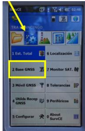
Imagen No. 3.2.2.9. – Selección Base GNSS Fuente: Elaboración propia
