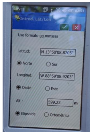
Imagen No. 3.2.2.14. – Introducción de Coordenadas de amarre Fuente: Elaboración propia
