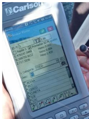
Imagen No. 3.2.2.23. – Medición de punto localizado Fuente: Elaboración propia
