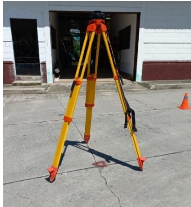
Imagen No. 3.2.1.2. – Centrado del trípode. Fuente: Elaboración propia
