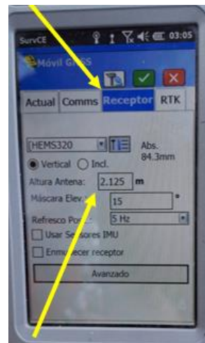
Imagen No. 3.2.2.19. – Ingreso altura del bastón con receptor
