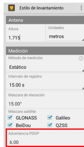
Imagen No. 3.2.1.13. - Configuración del PDOP Fuente: Elaboración propia
