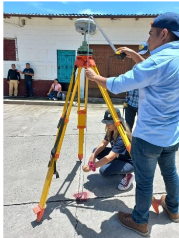
Imagen No.3.2.1.8. – Medición de la altura de antena Fuente: Elaboración propia
