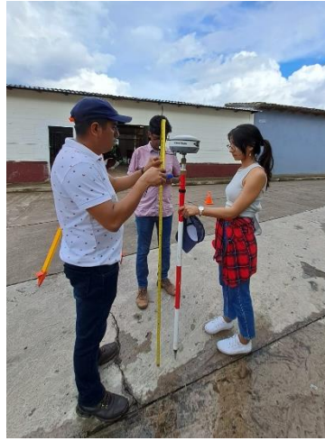
Imagen No. 3.2.2.16. – Medición de la altura del bastón con receptor Fuente: Elaboración propia
