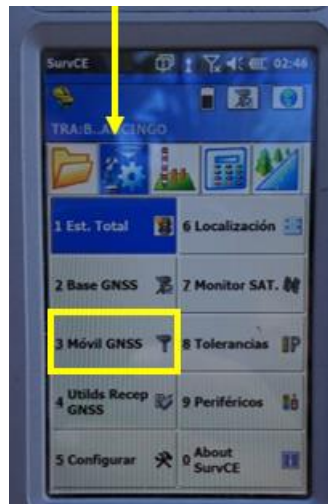
Imagen No. 3.2.2.17. – Selección Móvil GNSS Fuente: Elaboración propia
