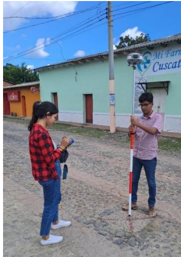
Imagen No. 3.2.2.22. – Fijación en el punto de control con receptor Rover Fuente: Elaboración propia
