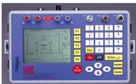
Figura 4.12. Resistivímetro SARIS empleado en la técnica de SEV.
