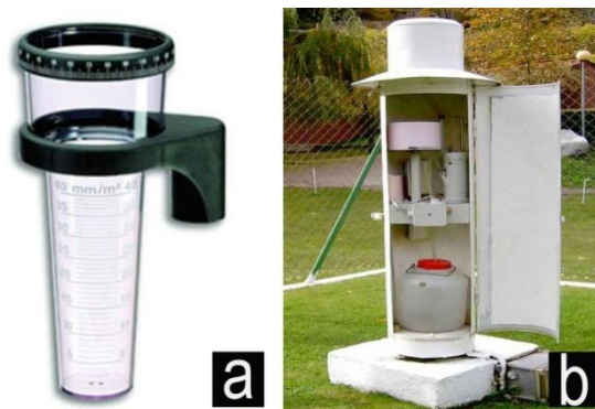
Figura 3.8. Instrumentos para la medición de la precipitación.
