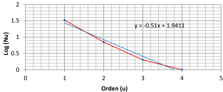
Figura D.1: Esquema grafico orden de corrientes vs Logaritmo de número de corrientes Fuente: Elaboración propia.
