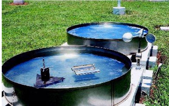
Figura 3.3. Tanque evaporímetro (Clase A).
