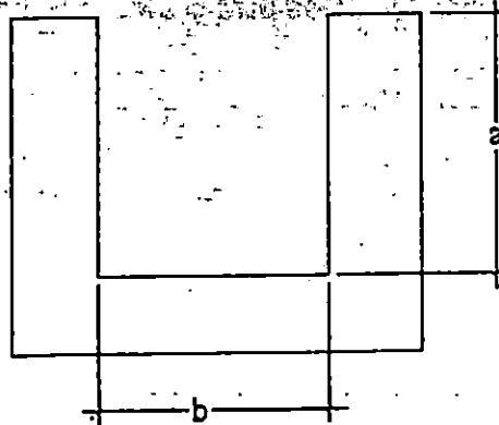
Fig. 4.8 Detalle de sección para canaleta de aguas lluvias ( De ladrillo bien construido y superficie repellada ); con n=0.013 , cotas en mts.
