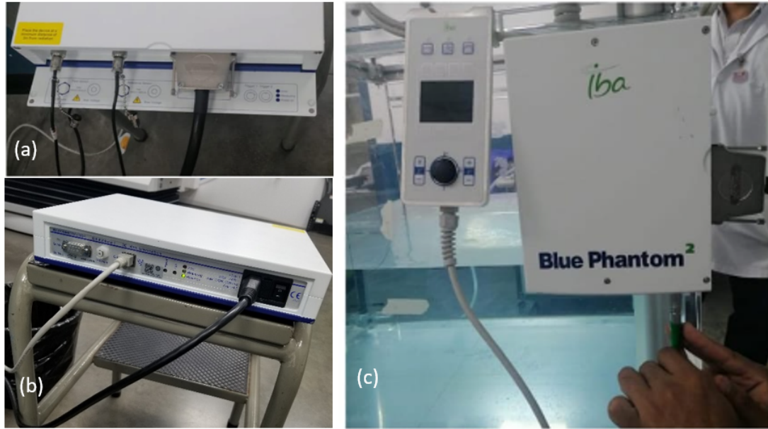
Figura 4.5: (a) Conexión a la CCU de las cámaras de ionización y a la derecha el cable PS2 (b) conexión de la CCU al cable de red que comunica con el exterior del búnker, (c) a la izquierda el control de mando del sistema de barrido del fantoma y a la derecha la consola conectada con el cable PS2 a la CCU.
