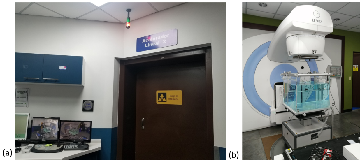
Figura 4.2: (a) Búnker donde se encuentra la sala de tratamientos del linac 2 del centro nacional de radioterapia. (b) Linac Elekta Synergy del 6MV.
