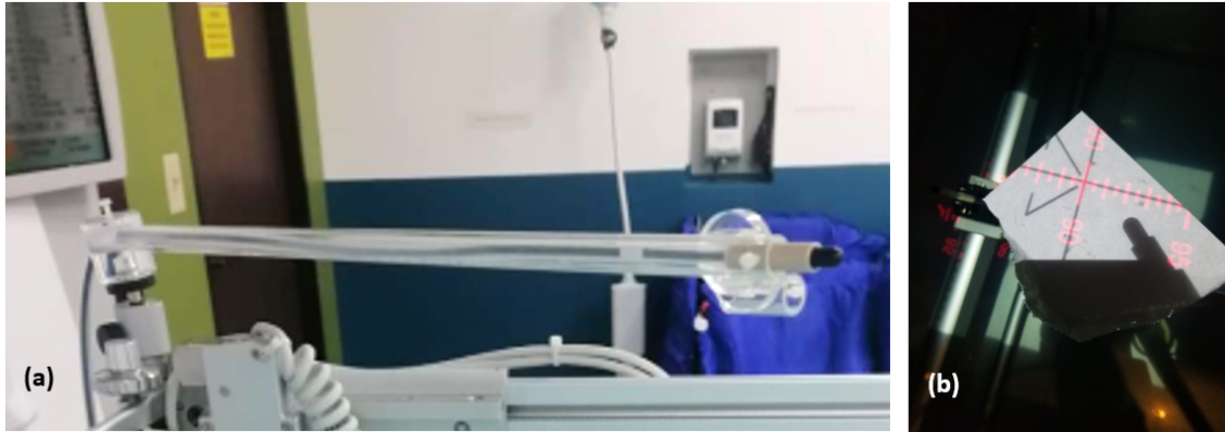
Figura 4.6: (a) Posicionamiento de la cámara de referencia CC13 15631 al exterior del fantoma, (b) el detector no debe interferir en los recorridos de escaneo: la sombra no interseca las líneas de retícula. Se observa además que en la hoja de papel bond se lee la distancia SSD que indica el telémetro.
