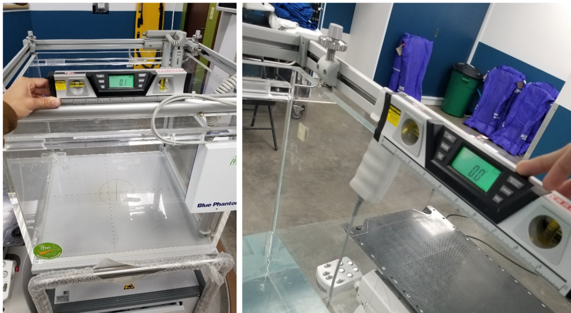
Figura 4.3: Uso del nivel de gota para verificar que no exista inclinación del fantoma y de los rieles para el barrido del detector.
