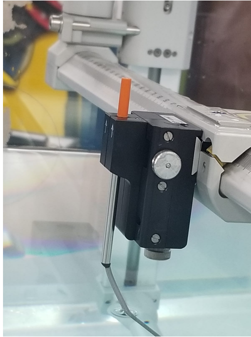
Figura 3.20: Detector de tipo diodo marca IBA y su posicionamiento dentro del fantoma de agua.
