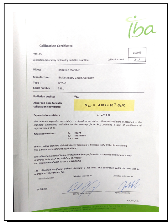
Figura 3.26: Certificado de calibración de la cámara de ionización FC65-G de IBA. Obsérvese el coeficiente de calibración y su incerteza expandida.
