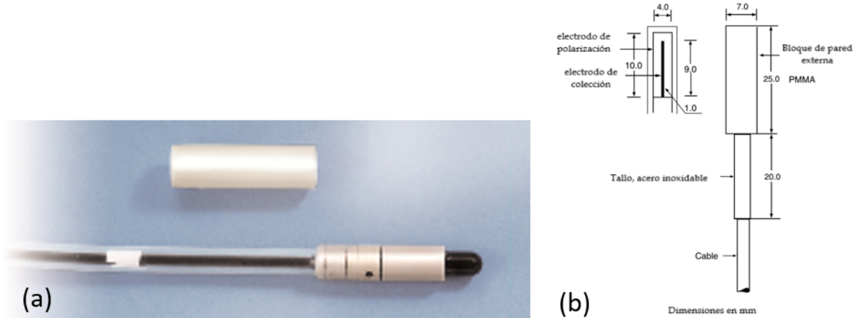
Figura 3.19: (a) cámara de ionización CC13 marca IBA. Fuente: iba-dosimetry (2023) . (b) esquema y dimensiones (en mm) de una cámara de ionización común de volumen pequeño ( 0.12 \text{ cm}^3 RK model from Scanditronix) Fuente: Mayles et al. (2007) .
