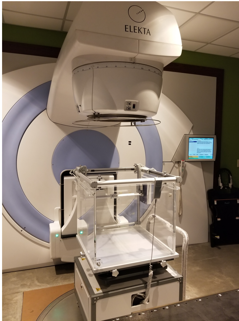
Figura 3.18: Sistema de un fantoma de agua controlado remotamente. Los detectores pueden ser posicionados dentro del fantoma de agua y desplazados bajo el control de una computadora.
