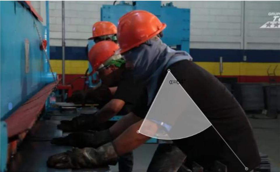
**Ilustración 61** Puntuación del antebrazo -  $\alpha = 71^\circ$
