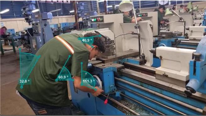
**Ilustración 72** Puntuaciones de operario de torno en diferente postura
