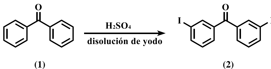
Figura 22. Reacción de síntesis de la 3,3'-diyodobenzofenona
