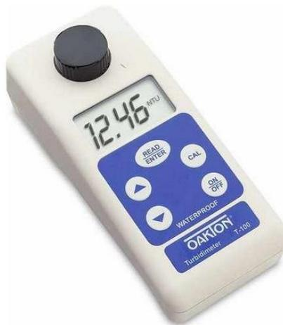
Nota: Turbidímetro a prueba de agua con rango de 0 a 1000 NTU, fuente de luz infrarroja, con set de patrones de calibración de 0.02, 20.0, 100 y 800. Fuente: tomado de Oakton Instruments (2022)
