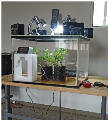
Anexo 20. Realización de pruebas de absorción de \text{CO}_2 a mayor escala con una planta entera, aplicando 549 lux.
