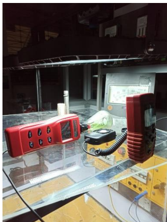
Anexo 31. Pruebas de absorción de CO 2 de una porción vegetal de maní forrajero dentro de un Erlenmeyer.
