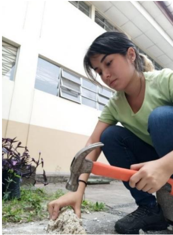
Anexo 22. Preparación de material filtrante a base de piedra pómez para la implementación del módulo.
