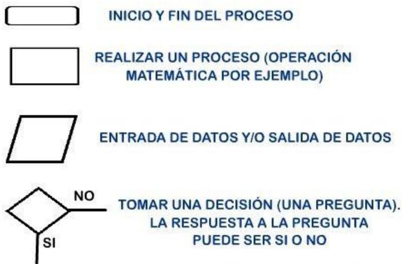
**Figura N°2** Símbolos Fundamentales en el Diagrama de Flujo <sup>17</sup>
