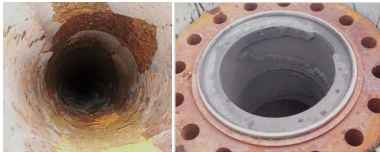
*Figura 2.1. Corrosión uniforme en estructuras de transporte de vapor geotérmico (Nogara, J., 2017).*
