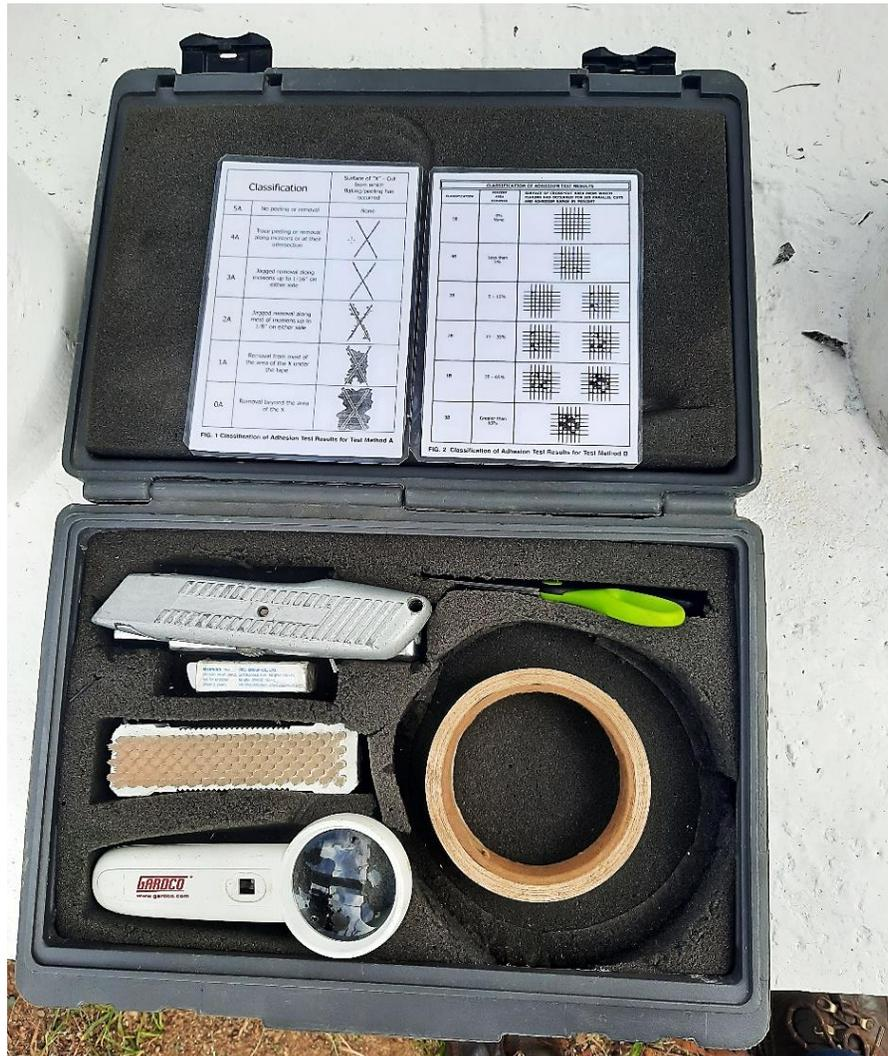
Figura 3.8. Kit para realizar prueba de adherencia según Norma ASTM D3359-17.
