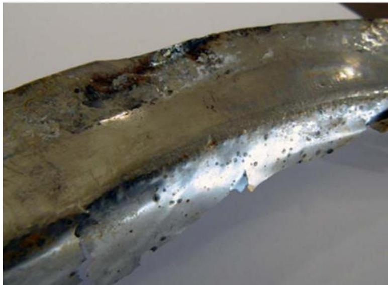
*Figura 2.2. Corrosión por picadura en material 316 L de un disco de ruptura en tubería de vapor geotérmico (Nogara, J., 2017).*
