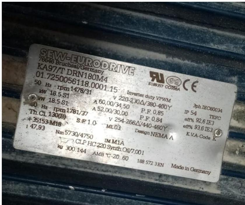
Figura A - 8 Ficha técnica mezcladora 1000 Kg
