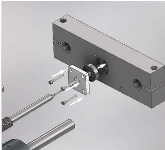
Fig. B.33. Montaje de elementos 5, 6, 10 y 17.
