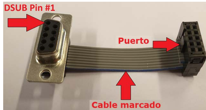
Fig. B.66. Cableado de la caja a la placa de circuitos.
