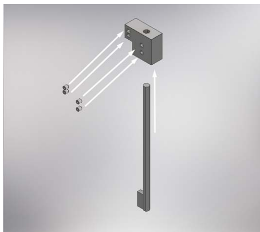
Fig. B.19. Montaje de regletas superior e inferior.
