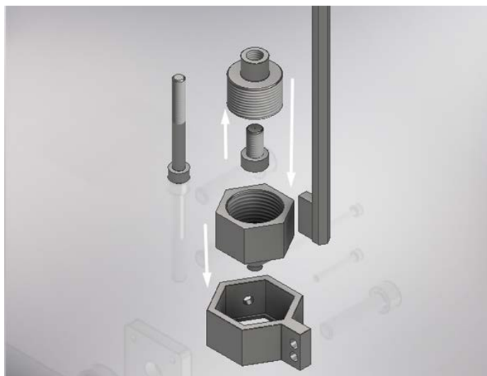
Fig. B.18. Armado y montaje de boquilla superior.
