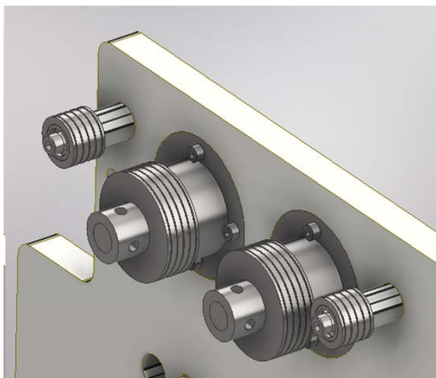
Fig. B.10. Correcto montaje de poleas.
