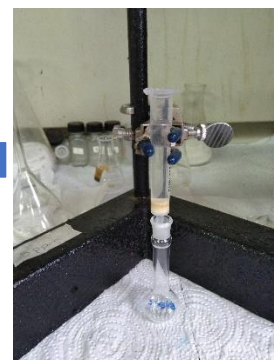
Depositar la muestra en balón de 5 mL utilizando acetato de etilo.
