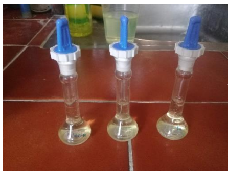
Muestra aforada con fase móvil (72:13:12 ácido oxálico/acetonitrilo/metanol)
