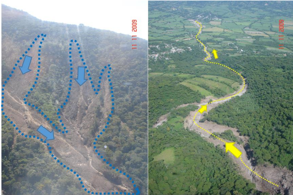
Figura N° 3: Zonas de liberación u origen y canal de transporte de flujos de escombros, flanco norte del volcán de San Vicente, 2009. Fotografías proporcionadas por MARN.
