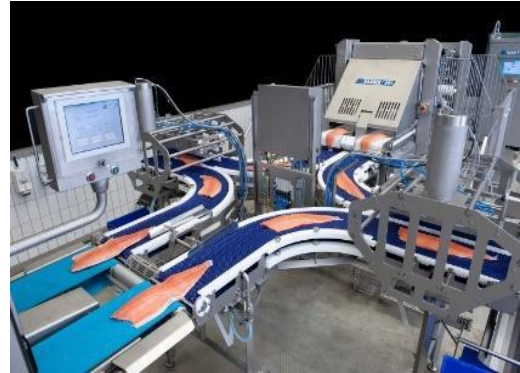
Ilustración 50. Fileteadora marca BAARDER
