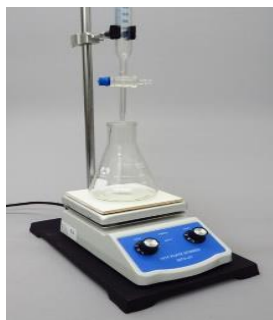
Figura 20. Sistema de reacción de disolución A y B. Imagen Tomada de: L. Conecctions, «Labconusa,» [En línea]. Available: https://www.labconusa.com/Titration-Set-100-mL-Glass-Stopcock-Buret-with-Hot-Plate-Stirrer.html . [Último acceso: 22 febrero 2021].
