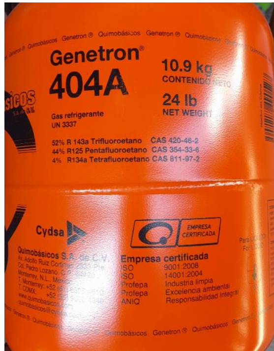
Figura A.4 Tanque de 10.9 kg de Refrigerante 404-A utilizado para la recarga en los equipos de refrigeración.
