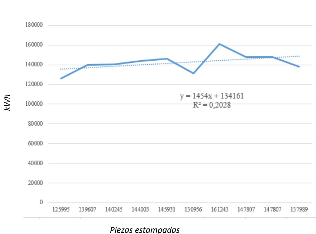
Figura 5.9. Gráfica de consumo kWh gastados vs piezas estampadas.
