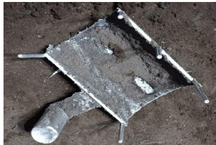
Figura 3.6. Fase de secado de la mitad del ánodo de zinc posterior al moldeado en caliente.
