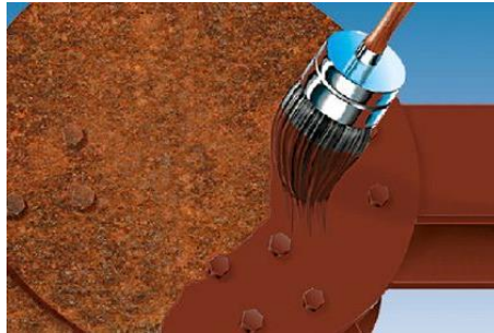
Figura 2.5. Ejemplo de aplicación de recubrimiento del tipo barrera. (Tomada de “El Estado del Material a Proteger”, S.F., TCRPAINT)
