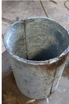
Figura 3.7. Resultado final de la fabricación del ánodo de zinc.
