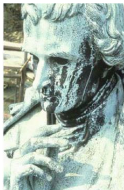
Figura 2.1. Indicios de corrosión en la estatua del monumento a Thomas Jefferson. (Tomado de “Introduction to Corrosion Science”, E. McCafferty, 2010, New York, USA)
