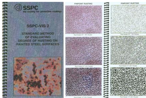
Figura 2.9. Normativa SSPC-VIS 2: Método de evaluación estándar del grado de oxidación de superficies de acero pintadas, utilizada para la evaluación de la superficie de los pasamanos del muelle del Puerto la Libertad
