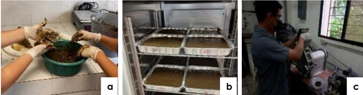
**Figura 13.** Mezclado de muestras de heces (a) Secado de muestras en estufa ventilada (b) Molido de muestras secas de heces (c).
