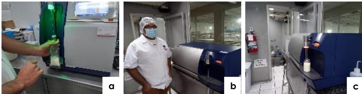
**Figura 18.** Recuento de células somáticas en BacSomatic™ (a) Aparato Foss MilkoScan F1 (b) Determinación proteína, grasas, sólidos totales (ST), lactosa y N ureico en leche en Foss MilkoScan F1 (c).
