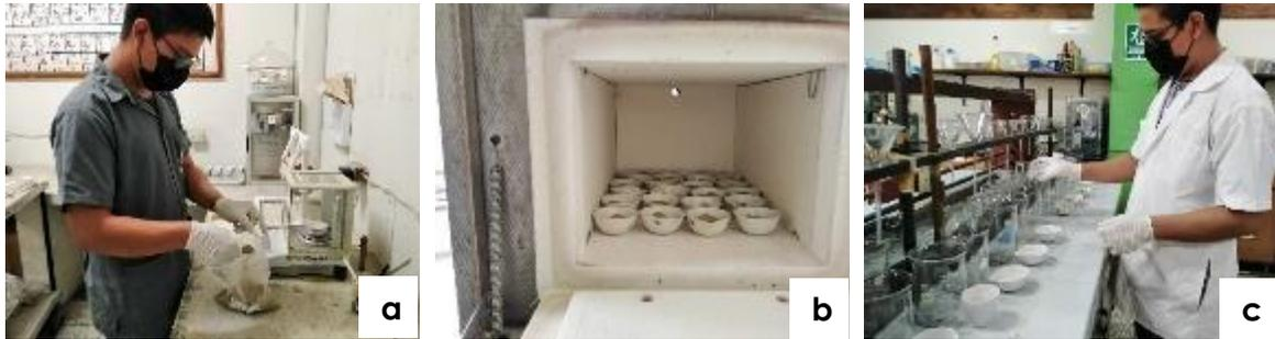
**Figura 16.** Pesaje (a) Calcinación de muestras en horno mufla (b) Determinación de CIA (c).
