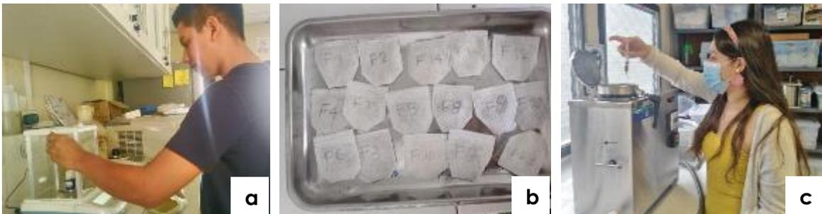
**Figura 15.** Pesaje (a) Identificación de muestras (b) Aplicación de amilasa termoestable (c) para determinación de FND y FAD.
