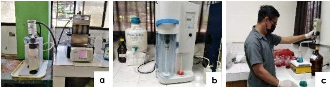
**Figura 14.** Digestión (a) Destilación (b) Titulación de muestras (c) por procedimiento Kjeldahl.
