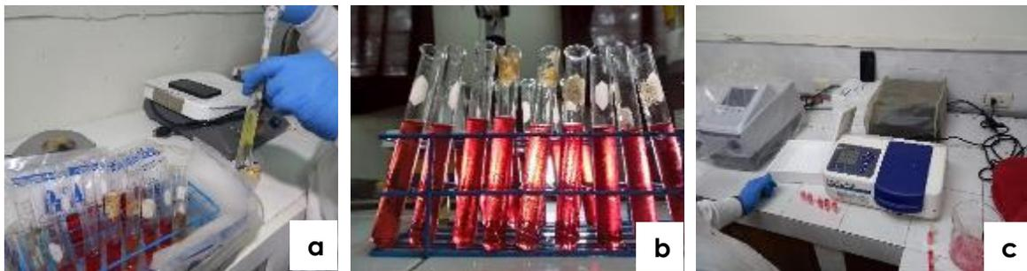
**Figura 17.** Preparación de solución (a) Diferentes concentraciones de solución (b) Uso de espectrofotómetro (c) para determinación de alantoína.
