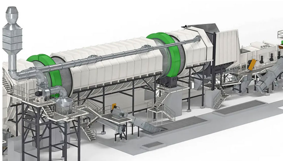
Figura 2.2: Esquema de una máquina de descortezado de troncos. Fuente: sitio web de Valmet (agosto de 2023)
