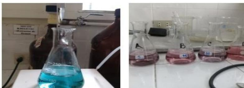
Figura A-5. Titulación de muestras para la determinación de nitrógeno proteico por el método de micro Kjeldahl.
