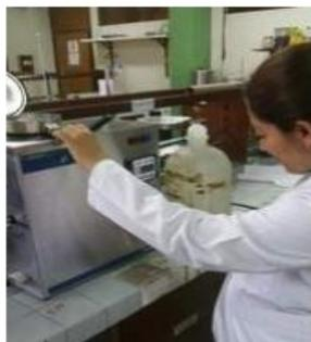
Figura A-6. Determinación de fibra cruda con el equipo de análisis de fibra Ankom.
