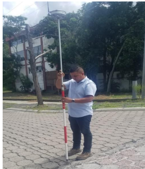
Imagen 4.2-15: Montaje de GPS base y Rover.
