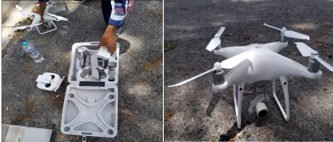
Imagen 4.8: Armado y calibración del dron.
