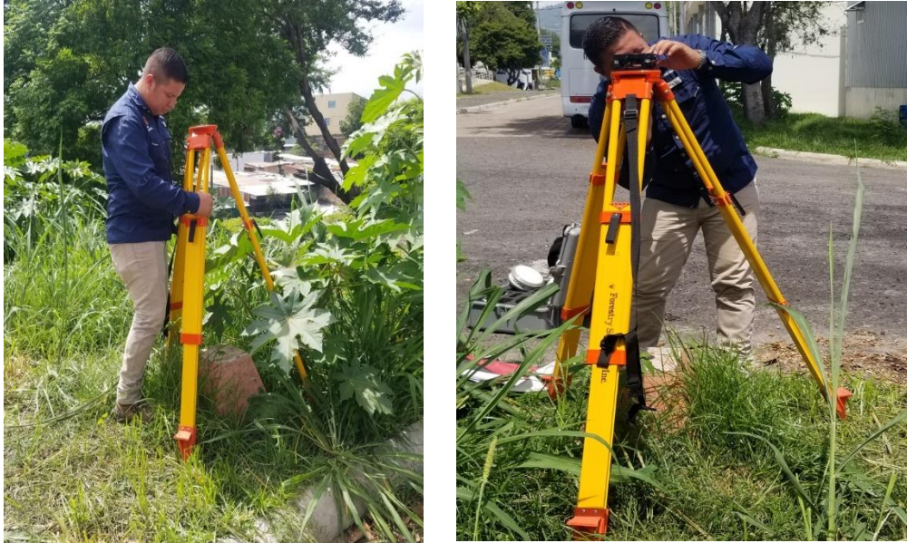
Imagen 4.16: Montaje de Trípode para instalar base nivelante.
