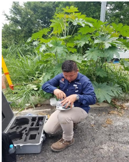
Imagen 4.17: Instalación de Batería a Base GPS.
