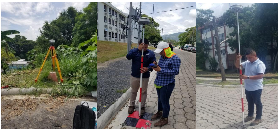
Imagen 4.20: Levantamiento de los PCF en Villa UES.
