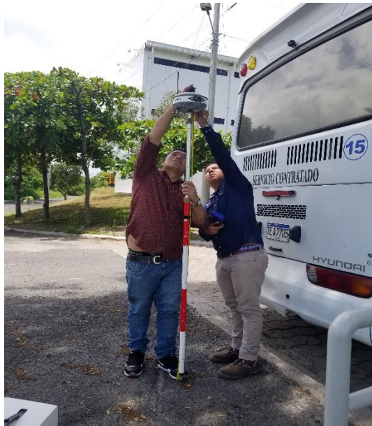
Imagen 4.18: Montaje del GPS Rover.
