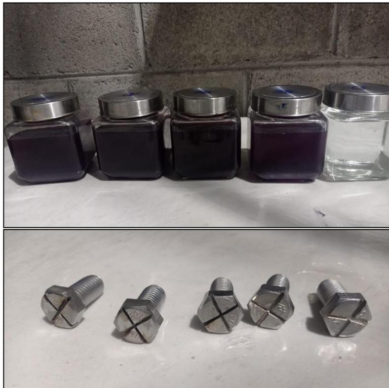
*Ilustración 3.3 Pernos de acero con corte en forma de “X” y recipientes de muestras.*
