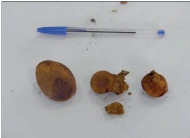
Ilustración 2.8 Tubérculos típicos de corrosión bacteriana en tuberías de hierro. (Marín, 2003)
