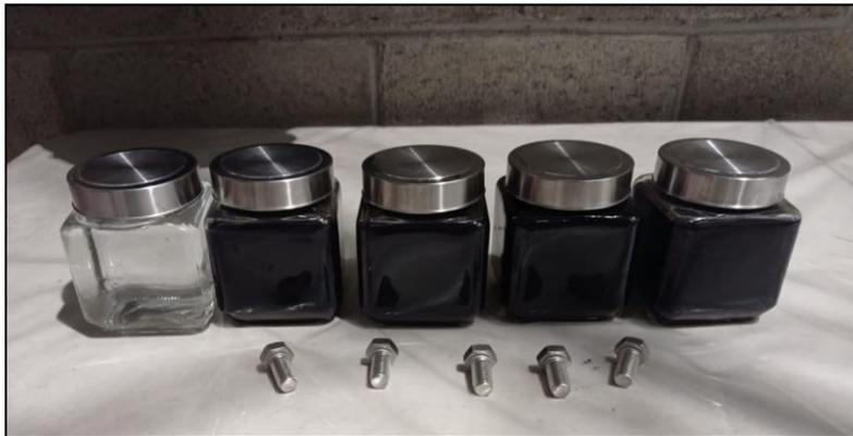
Ilustración 3.2 Disposición de frascos con diferentes concentraciones de aguas residuales.
