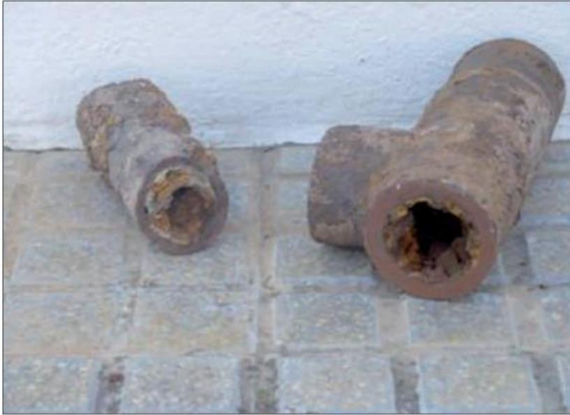
*Ilustración 2.7 Corrosión electroquímica interna y externa en tuberías de fundición de hierro. Obsérvense tanto picaduras y perforaciones como acumulaciones de depósitos. (Marín, 2003)*
