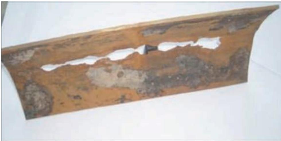
*Ilustración 2.5 Trozo de tubería metálica severamente corroída mostrando zonas totalmente perforadas. (Marín, 2003)*
