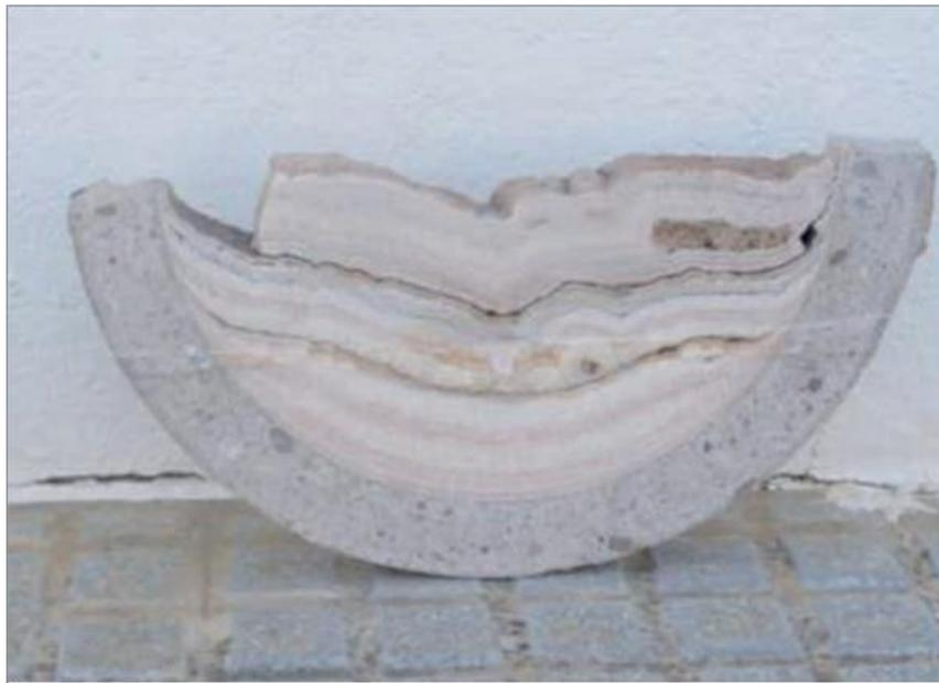
*Ilustración 2.1* Conducción de agua con deposiciones calcáreas debidas al efecto de aguas incrustantes (precipitación de  $\text{CaCO}_3$  y otros materiales asociados). (Rodríguez & Marín, 1999).
